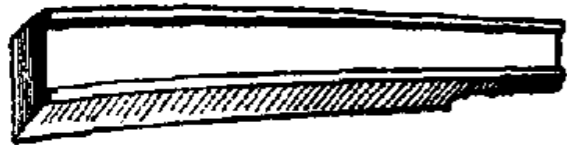
FIG. 895. — Entaille pour raboter la touche.
