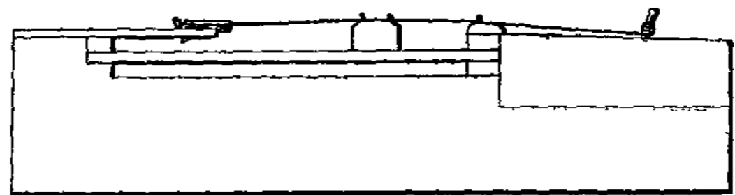
FIG. 1075. — Corde tendue sur le chevalet.
