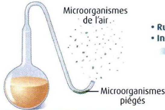
La courbure inférieure du col en forme de S emprisonne les microorganismes ; le bouillon reste stérile
