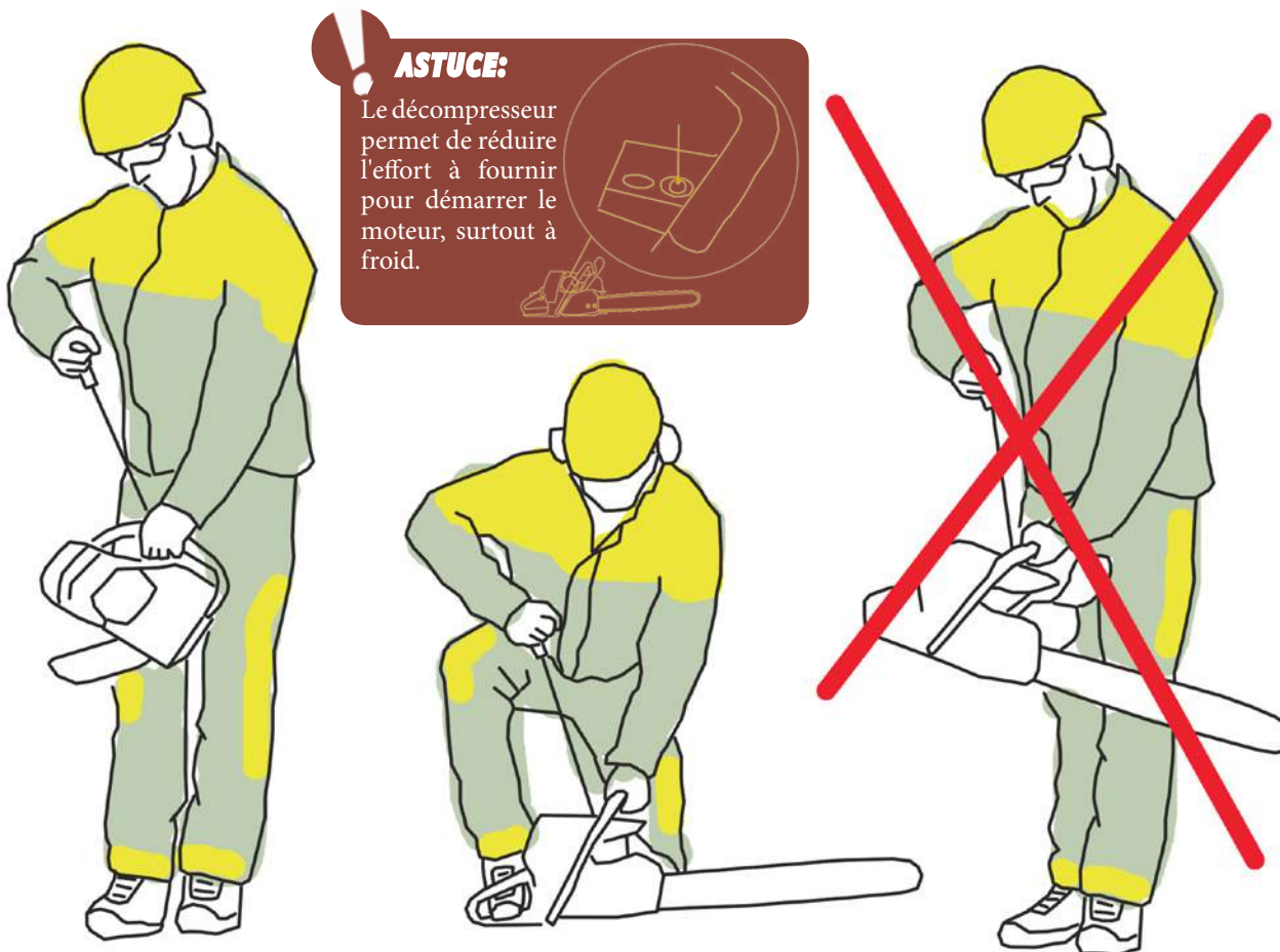
△ Positions correctes pour allumer une tronçonneuse △
