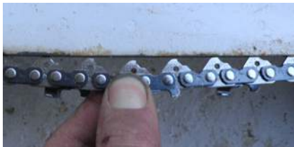
▲ Chaîne tendue correctement : en tirant avec les doigts la chaîne sort du guide, mais une fois relâchée elle revient à sa position initiale.
