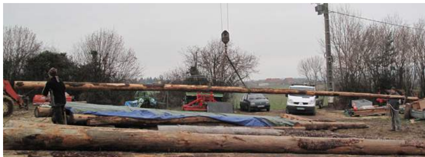
▲ Essayez de positionner l'élingue sur les points d'équilibre de la grume, sachant que, vu la configuration de l'arbre, une extrémité est sûrement plus lourde que l'autre.
