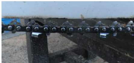
▲ Chaîne complètement détendue : les maillons d'entraînement sont complètement visibles.
