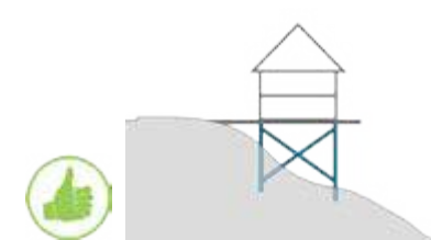
Construction sur pilotis
