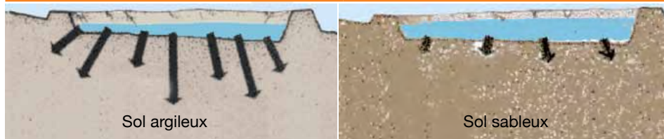
Figure 21. Imperméabilité des sols argileux et sableux.
