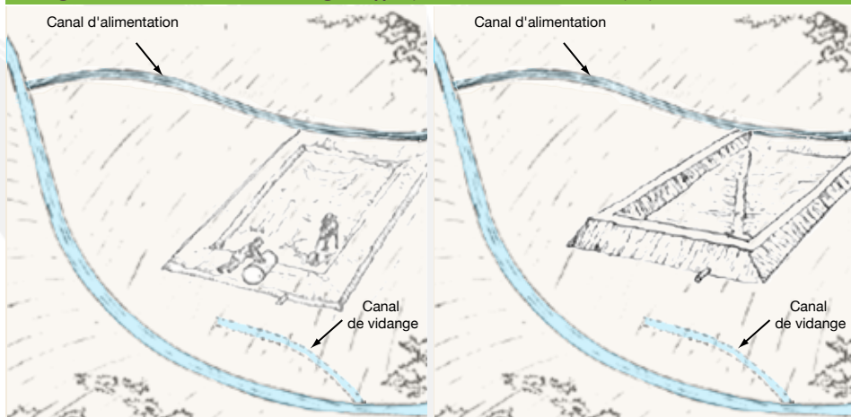
Figure 70. Construction des digues (II).
