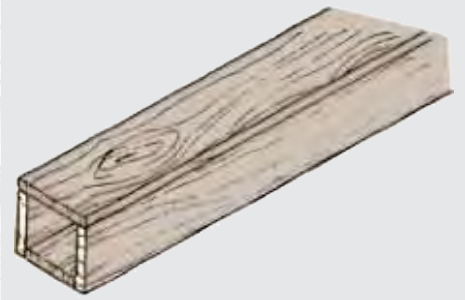
Figure 87. Canalisation en bois.
