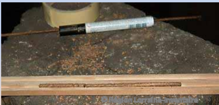
Prélèvement à la perceuse, cathédrale de Metz.
