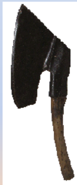
Équarrissage à la doloire ou « épaule de mouton » (89-Guédelon, château).
