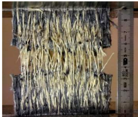
Figure 4.26. Résultat de l'assemblage bout à bout.
