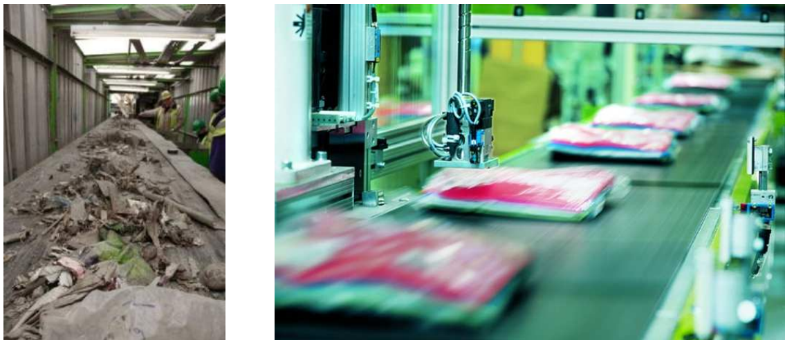
Figure A.4. Exemples de bandes plates : tri de déchets et convoyage de marchandise.
