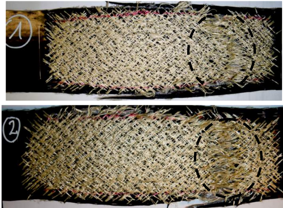
Figure 4.62. Jonctions cousues rompues.
