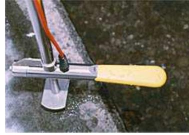
FIGURE 6.4 – Courantomètre électromagnétique (photo OTT)
