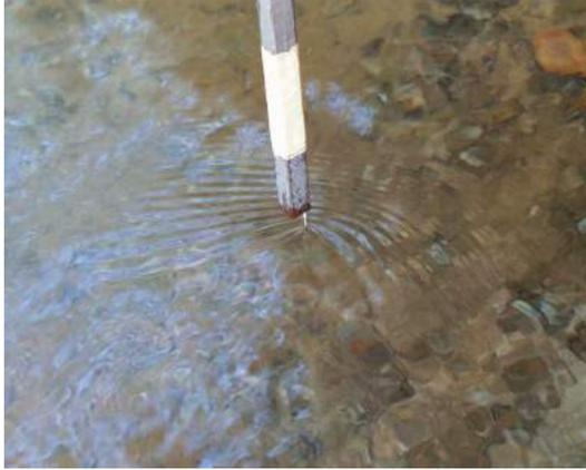
FIGURE 4.9 – Remontée des ondes en régime fluvial
