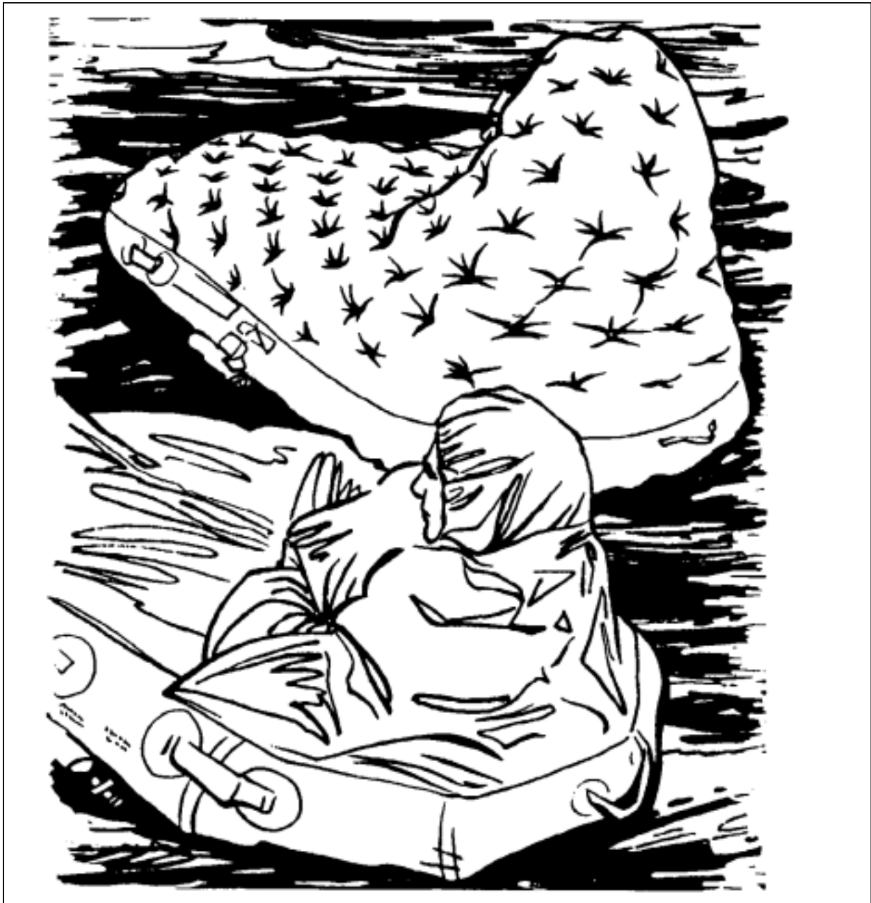
Figure 16-11 : Radeau monoplace, avant et après le gonflement de la tente
