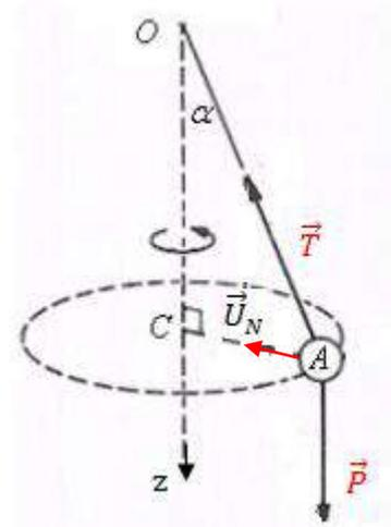
Bilan des forces appliquées sur la masse  $M$  :  $\begin{cases} \vec{P} = m\vec{g} : \text{Poids de la masse } M. \\ \vec{T} : \text{Tension du fil.} \end{cases}$
