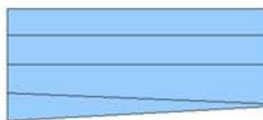
Le biais s'il n'est pas très important est récupéré avec un coyau
