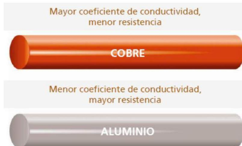
On en conclut que : plus le coefficient de conductivité du conducteur est élevé, plus la résistance au passage du courant est faible.
