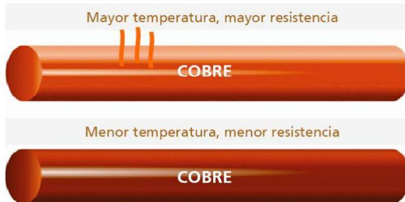
Par conséquent, nous concluons que : plus la température d'un matériau est élevée, plus la résistance du matériau est élevée.
