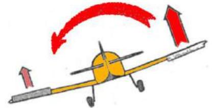
Pour modifier la portance des ailes on utilise des gouvernes appelées ailerons. Ces gouvernes sont situées en bout d'aile (pour augmenter leur surface portante) et permettent d'obtenir un effet opposé sur les deux ailes par un braquage différentiel. On baisse l'aileron du côté où il faut diminuer la portance et on le relève du côté où il faut la
