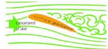
Le **coefficient de portance  $C_z$**  (et donc la portance) de l'aile augmente lorsque l'**angle d'incidence** augmente. Cependant, indépendamment de la vitesse de l'avion,  **$C_z$**  connaît un maximum, atteint pour un certain angle d'incidence (15 à 18° selon les profils).
