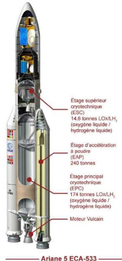
Selon la 3<sup>ème</sup> loi de Newton : principe de l'action et de la réaction, la masse de gaz éjectée vers l'arrière génère une force vers l'avant nommée :
