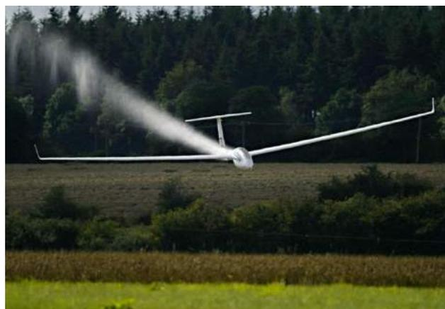
Planeur à réaction ? Non vidange des "water ballasts" !
