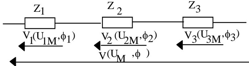
Aux bornes de  $Z_1$  nous avons une tension  $V_1$  d'amplitude  $U_{1M}$ , de phase.
