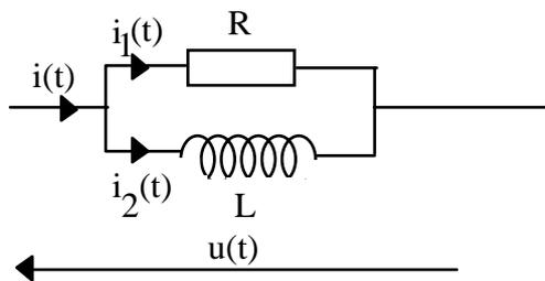
Quand on applique  $u(t)$  à ses bornes, il apparaît un courant alternatif  $i(t)$  dans le circuit, se divisant en deux :  $i_1(t)$  dans la résistance et  $i_2(t)$  dans l'inductance.
