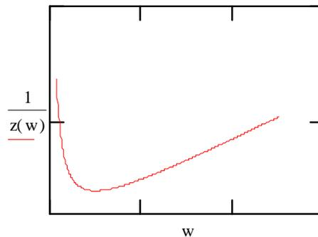
$\omega_0$  est appelé fréquence d'antirésonance . Comme  $I$  est proportionnel à  $1/Z$ , la courbe  $I$  en fonction de  $\omega$  se déduit directement de la précédente et a la même allure.
