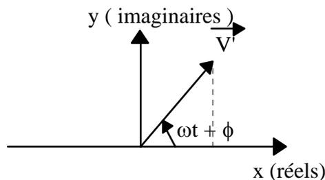
Soit  $V_M$  le module constant de ce vecteur : c'est l'amplitude de la tension.
