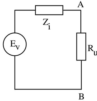
Déterminons la tension  $V_{AB}$  ( tension entre les bornes A et B ) :
