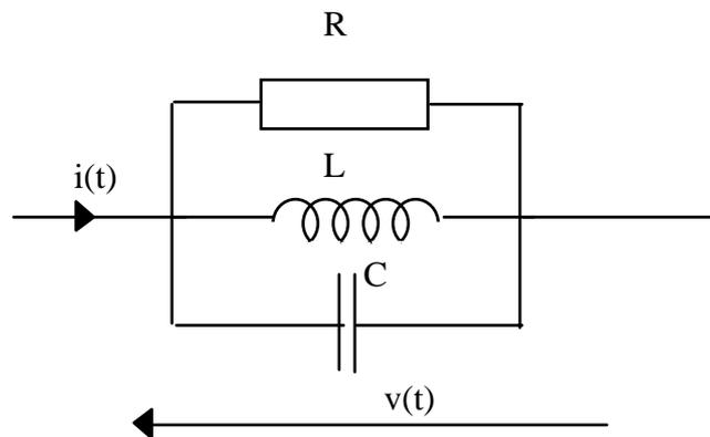
Soit le circuit ci-dessus, comportant en parallèle une résistance, une inductance et une capacité, alimenté par une d.d.p alternative  $v(t)$  et parcourue par un courant  $i(t)$  alternatif .
