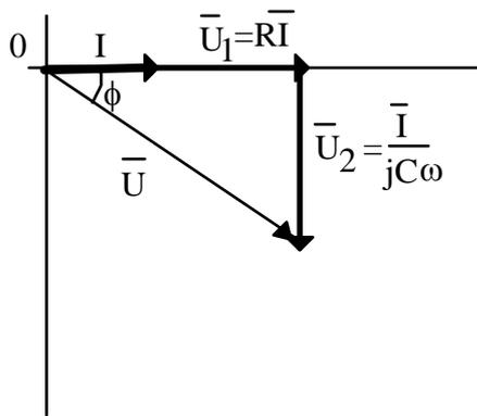
Nous vérifions que  $U$  est la somme des d.d.p  $U_1$  et  $U_2$  aux bornes de la résistance  $R$  et de la capacité  $C$ . Nous vérifions aisément que :  $\text{tg}\phi = -\frac{1}{RC\omega}$ .
