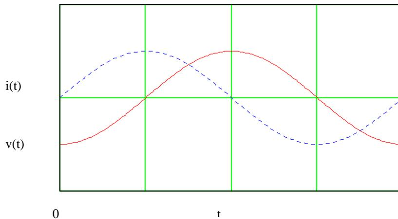
Exemple : à l'instant  $t = 0$ ,  $i(t) = 0$ ; la phase de la fonction  $v(t)$  est  $-\pi/2$ , donc  $v(t) = -V_M$ , la fonction passe donc par un minimum comme l'indique la courbe.
