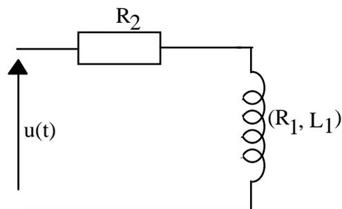
On mesure l'intensité efficace  $I$  du courant, les tensions efficaces  $U$  aux bornes du générateur,  $U_1$  aux bornes de la bobine et  $U_2$  aux bornes de la résistance  $R_2$ . On constate  $U_1 = U_2$ .
