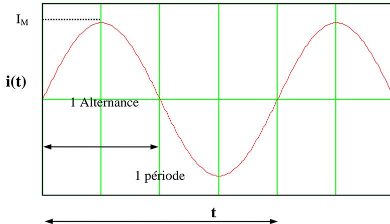
Le courant alternatif sera provoqué par une tension alternative sinusoïdale qui a pour équation :
