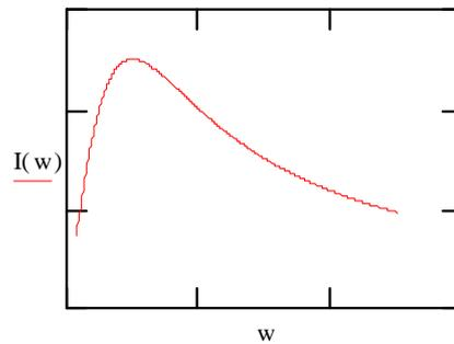
Le courant traversant le circuit a une amplitude maximale pour la pulsation :
