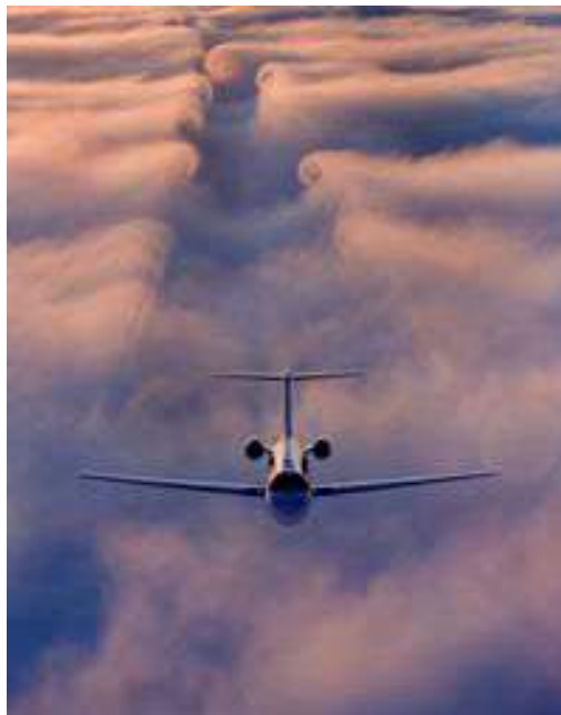
Figure 4.7. Déflexion vers le bas du flux d'air.
