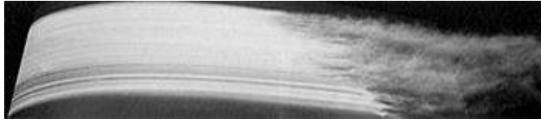
Figure 5.13. Transition de l'écoulement laminaire devient turbulente
