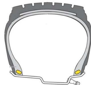
Fig. 8-11 Neumático sin cámara
