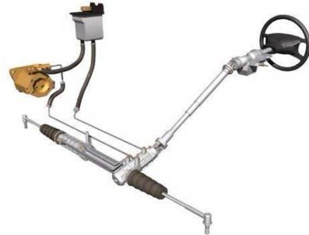
Fig. 9-6 Conjunto del sistema de dirección
