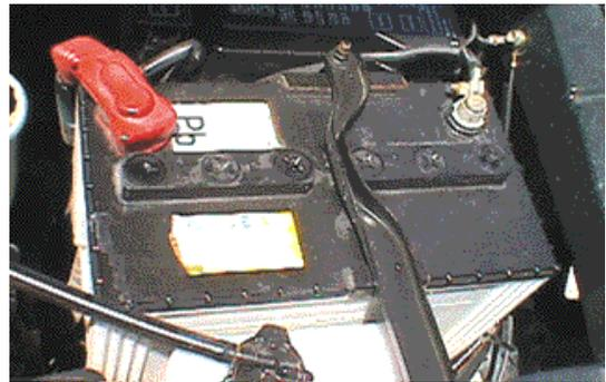
Fig. 6-5 Sujeción de la batería
