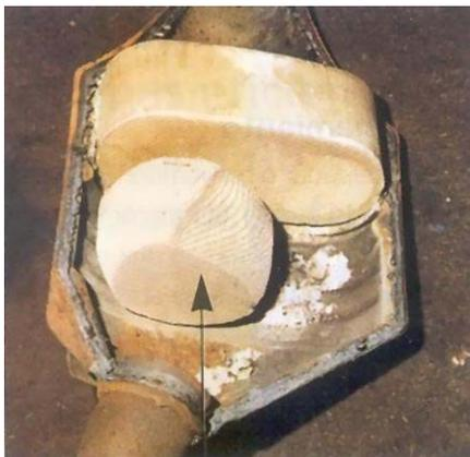
Fig. 4-11 Desgaste y rotura del catalizador
