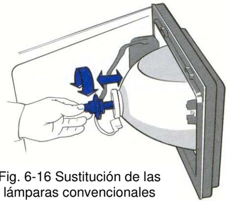
Fig. 6-16 Sustitución de las lámparas convencionales
