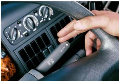
Fig. 10-15 Accionamiento del ralentizador
