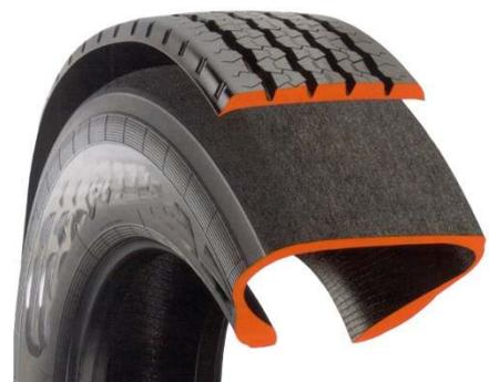
Fig. 8-17 Aplicación de una nueva banda
