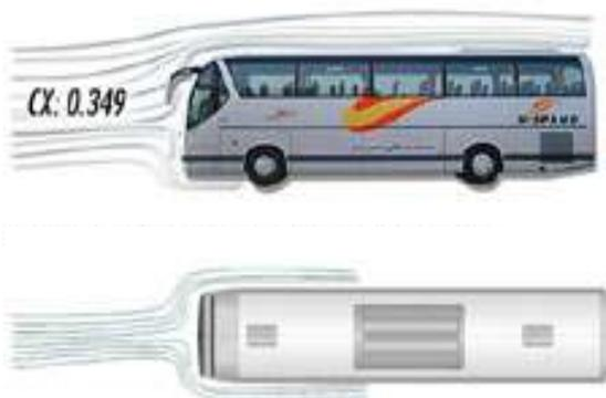
Fig. 1-12 Cálculo del coeficiente  $C_x$
