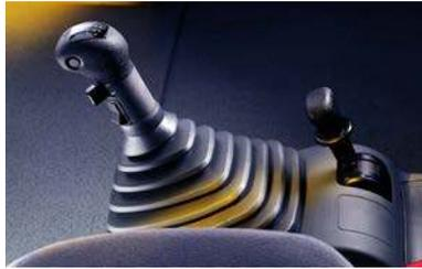
Fig. 7-19 Palanca para el grupo antepuesto y pospuesto
