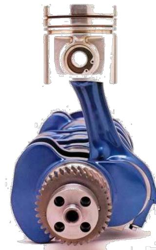
Fig. 2-8 Unión Pistón-Biela-Cigüeñal
