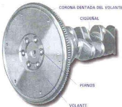
Fig. 2-9 Volante de inercia
