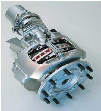
Fig. 10-4 Discos ventilados
