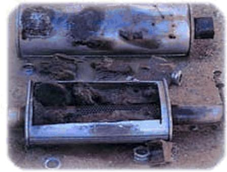
Fig. 4-10 Fusión del interior del catalizador
