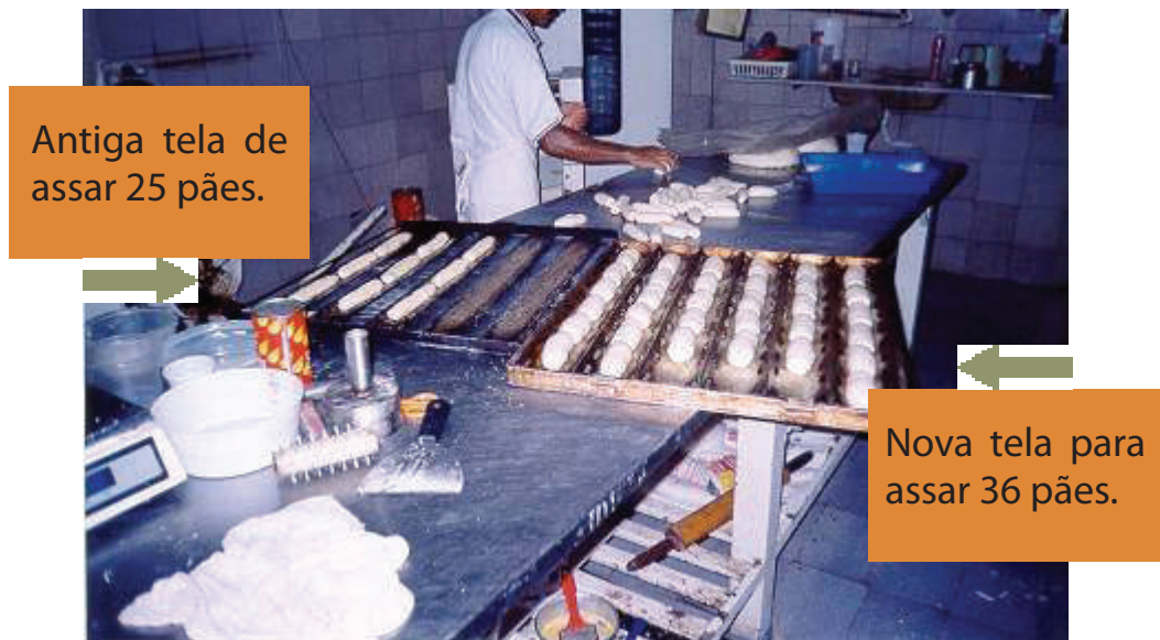
Figura 26 – Substituição das telas acondiciona-
