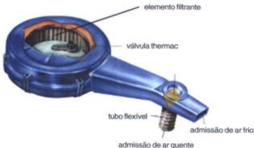
Figura 114 - Componentes do filtro de ar
