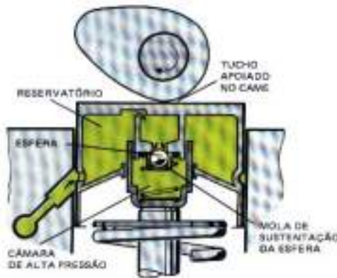
Figura 36 – Início de abertura da válvula Fonte: Manual Tucho Hidráulico – VW
