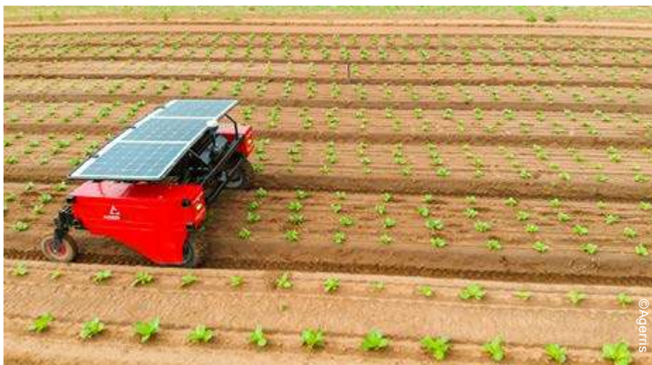
Figura 6. Robot alimentado por energía solar (Agerris Farmhand, Australia)
