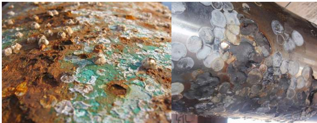
Figura 6. Corrosão em materiais metálicos claramente associada à fixação das cracas e ostras. © Rafal Konkolewski, Creative Commons Attribution ShareAlike 2.5 license. https://www.boats.com/how-to/are-barnacles-eating-my-propeller-shaft/ .
