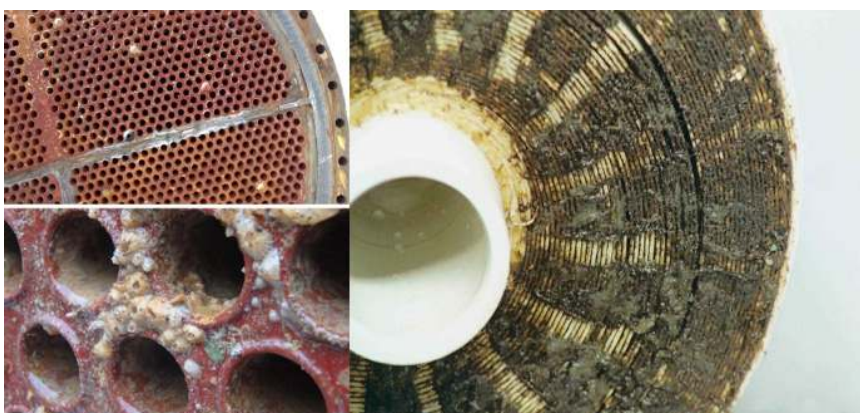
Figura 4. Crescimento biológico em trocadores de calor (à esquerda, foto: http://www.heatexchangera-sia.co/tubular-heat-exchanger/thumb/tubular-heat-exchanger-in-india.jpg ) e membranas de osmose reversa (à direita, http://heatxcoatings.com/fouling-shield/ ).
