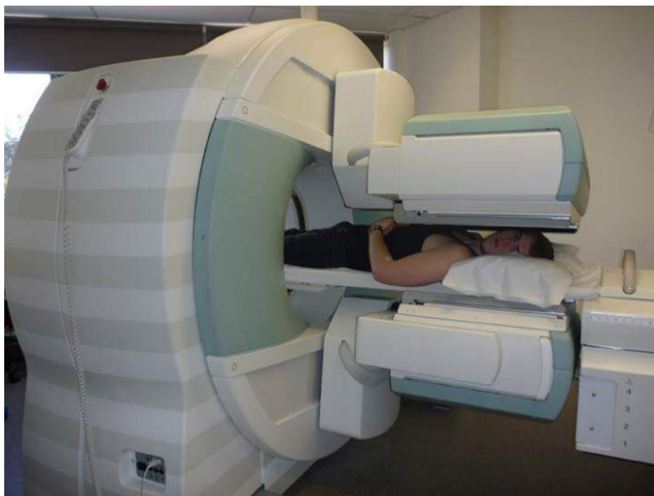
FIGURA 10.28 La máquina de SPECT utiliza compuestos radiofarmacológicos para producir una imagen del cuerpo humano. La máquina aprovecha la física del decaimiento del pulso nuclear y las colisiones electrón-positrón (crédito: "Woldo"/Wikimedia Commons).
