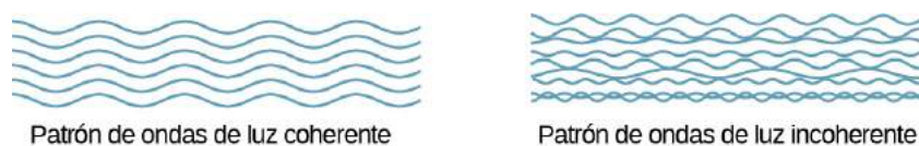
FIGURA 8.29 Un patrón de ondas de luz coherente contiene ondas de luz de la misma frecuencia y fase. Un patrón de ondas de luz incoherente contiene ondas de luz de diferentes frecuencias y fases.
