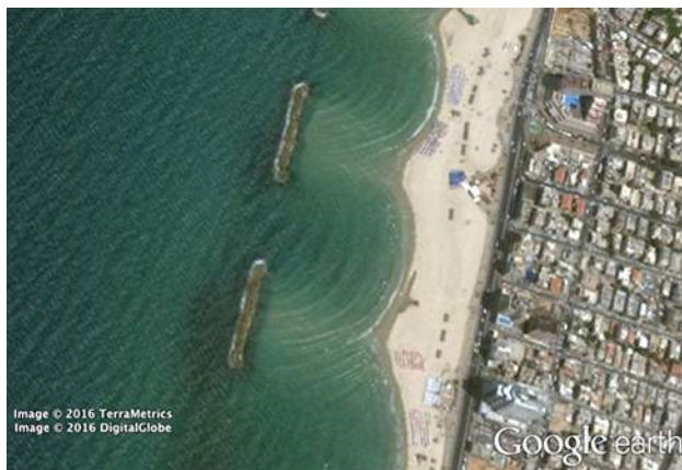
FIGURA 4.2 Debido a la difracción de las ondas, las olas del océano que entran por una abertura en un rompeolas pueden propagarse por toda la bahía. (crédito: modificación de los datos del mapa de Google Earth)
