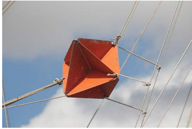
FIGURA 1.11 Un reflector de radar izado en un velero es un tipo de reflector de esquina. (crédito: Tim Sheerman-Chase)
