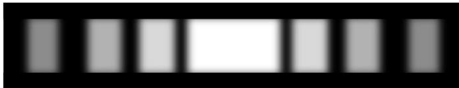
FIGURA 4.9 (a) La distribución de intensidad calculada de un patrón de difracción por una rendija. (b) El patrón de difracción real.
