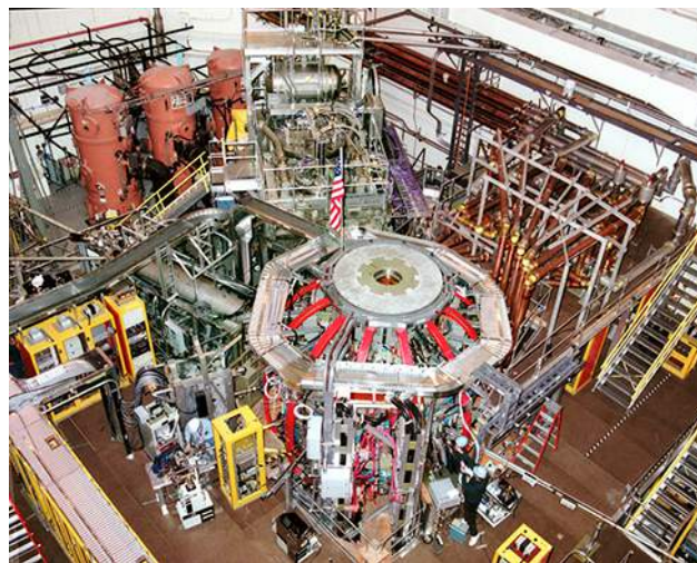
FIGURA 5.25 El Experimento Nacional de Torus Esférico (National Spherical Torus Experiment, NSTX) es un reactor de fusión en el que los isótopos de hidrógeno se fusionan para producir helio. En este proceso, una masa relativamente pequeña de combustible se convierte en una gran cantidad de energía (crédito: Laboratorio de Física del Plasma de Princeton).
