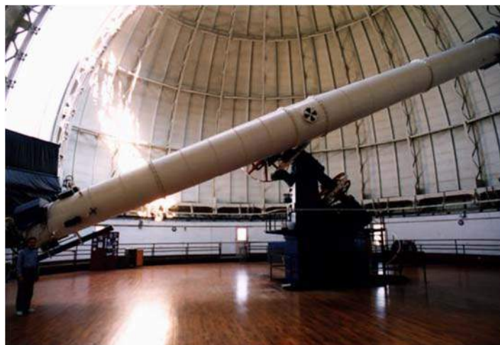
FIGURA 2.43 En 1897, el Observatorio Yerkes de Wisconsin (EE.UU.) construyó un gran telescopio refractor con una lente objetivo de 40 pulgadas (o 101 cm) de diámetro y una longitud de tubo de 62 pies (o 18,89 metros). (crédito: Observatorio Yerkes, Universidad de Chicago)
