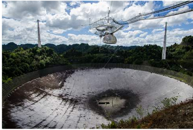
FIGURA 4.20 Un paraboloide de 305 m de diámetro en Arecibo (Puerto Rico) está revestido de material reflectante, lo que lo convierte en un radiotelescopio. Es el mayor plato de enfoque curvo del mundo. Aunque la D de Arecibo es mucho mayor que la del telescopio Hubble, detecta radiación de una longitud de onda mucho mayor y su límite de difracción es significativamente menor que el del Hubble. El telescopio de Arecibo sigue siendo muy útil, porque las ondas de radio transportan información importante que no transporta la luz visible. (crédito: Jeff Hitchcock)
