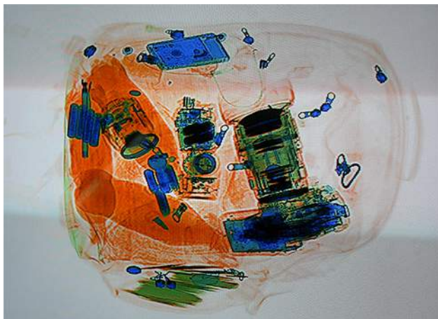
FIGURA 8.26 Una imagen de rayos X de un equipaje. Cuanto más denso sea el material, más oscura será la sombra. Los colores de los objetos se relacionan con la composición del material: los objetos metálicos aparecen en azul en esta imagen (crédito: "IDuke"/Wikimedia Commons).
