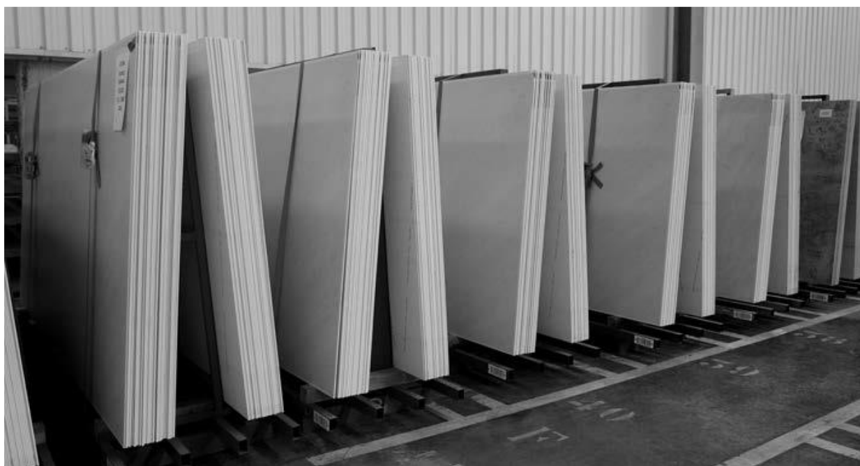
Пример решения хранения плит спеченного камня Delfone
