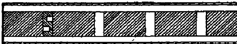
Fig. 151 — Compensado lamicorne, com as ripas intervaladas no centro, e unidas nas extremidades.
