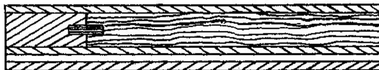
Fig. 158 — Compensado lamicerne, com laminado na frente.
