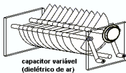
Figura 40: Estrutura física de um capacitor ajustável.
