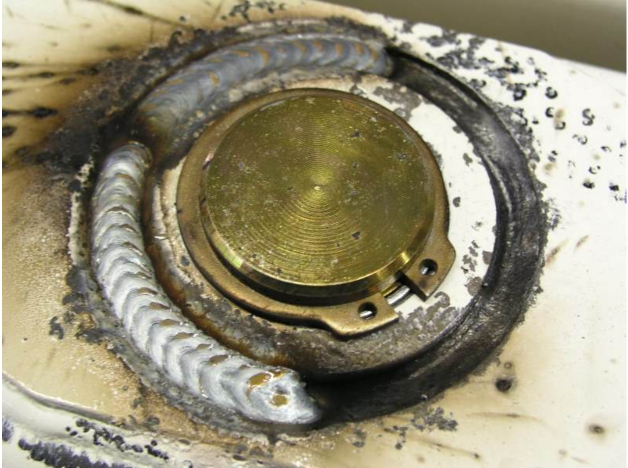
Photo 4: U Groove MIG Weld
