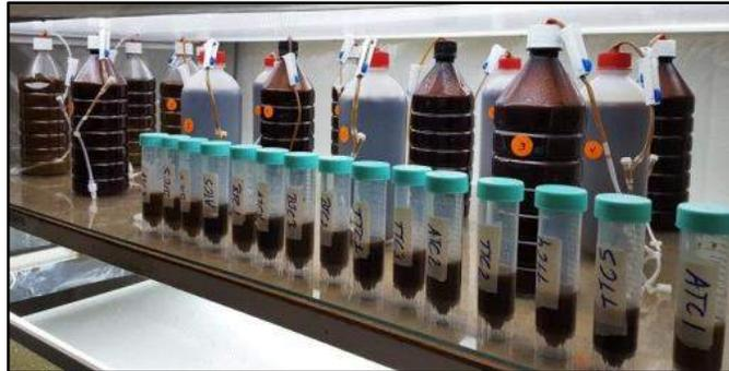
Figura 1. Evaluación de parámetros físicos-químicos del biofertilizante elaborado por el CIBE, envasado en Botellas PET (T-28) a una temperatura de 9.6°C.
