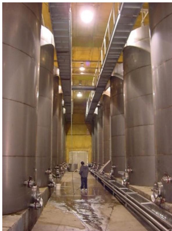
*Tanques de fermentación empleados para la producción de vinos de línea tradicional, con uva proveniente de viñedos de producción controlada.*
