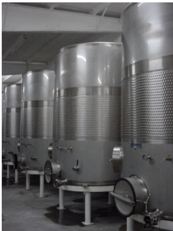
*Tanques de fermentación de pequeña capacidad. Este tipo de tanques se emplean para la elaboración de vinos de producción limitada , que se procesan en partidas muy pequeñas debido a que vienen de viñedos de producción restringida*
