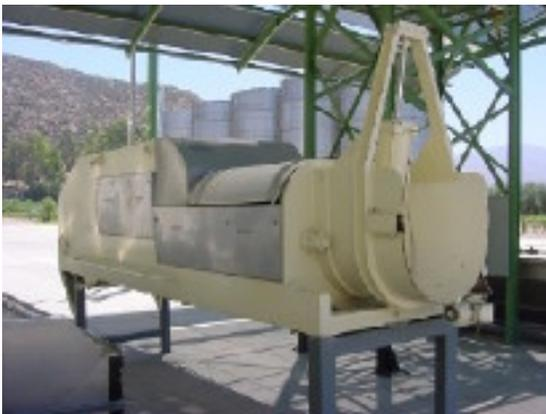
*Este tipo de prensas, a diferencia de las anteriores tiene la ventaja que trabaja en forma continua, es decir la alimentación, prensado y descarga ocurren simultáneamente en el tiempo, por lo que es mucho mas efectiva en el prensado de grandes cantidades de uva.*
