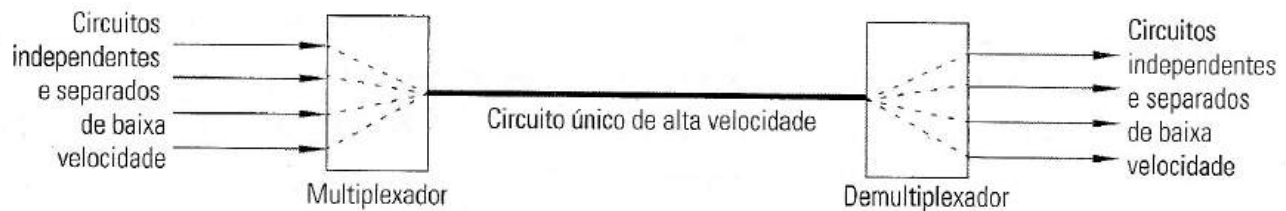
Figura 9: A multiplexação combina diversos recursos de transmissão separados em um único canal para fins de transmissão de dados.
