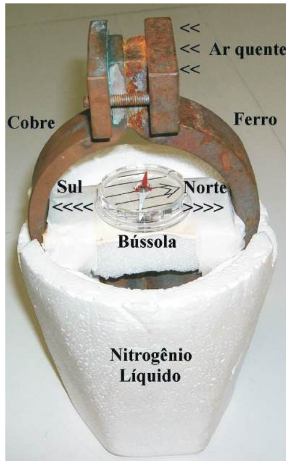
Figura A.4: Montagem experimental utilizada para observar o efeito Seebeck. O dispositivo mostrado foi idealizado e construído pelo Prof. Dr. Renê Ayres de Carvalho.
