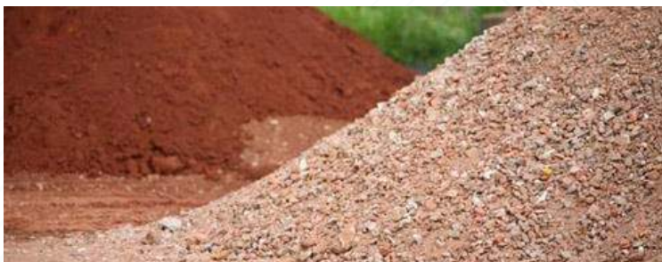
Figura 34 - Escalpe de solo de escavação, bica corrida mista. Imagem extraída a partir do Google images.
