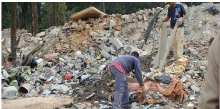
Figura 16 – Catação de contaminantes em pilhas cônicas. É o processo mais usado em usinas, porém ineficiente. Fonte: imagem obtida por Carina Ulсен.
