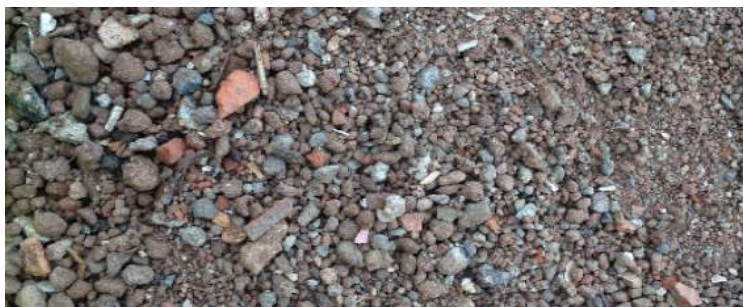
Figura 46 - Bica corrida reciclada (50-0mm), a partir de resíduo de construção misto (contendo cerâmica vermelha).
