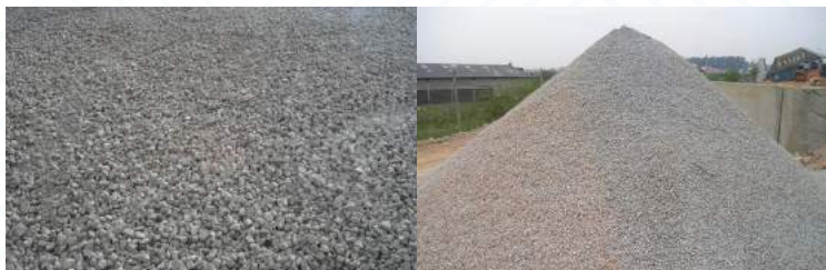
Figura 35 - Brita cimentícia (ou de concreto) 10-20 mm; pedrisco cimentício (< 5mm)
