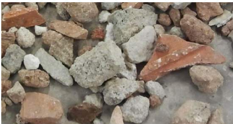
Figura 43 - Composição típica de um agregado reciclado misto. Essencialmente uma mistura de diferentes materiais cimentícios (concreto, argamassa), e também cerâmica vermelha, fragmentos de rochas, e contaminantes (madeira, asfalto, etc).
