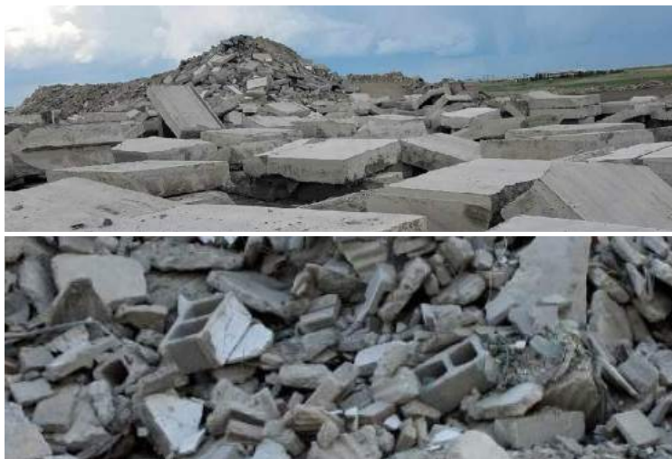
Figura 13 - Diferença entre resíduos de concreto estrutural (à esquerda) do resíduo cimentício (que contém blocos de vedação - alvenaria cimentícia, argamassas, etc) (à esquerda). Imagens obtidas através do Google Images.
