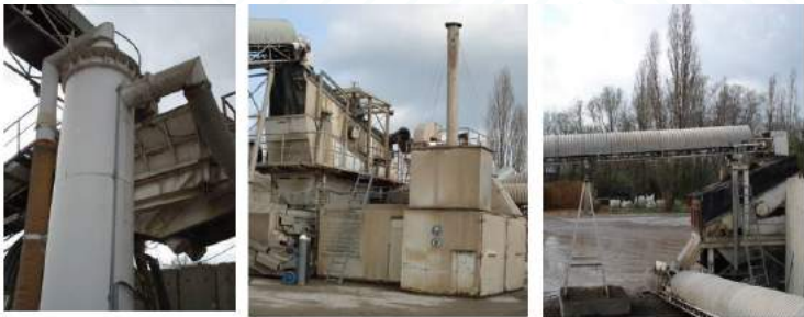
Figura 32 - Captação de material particulado em usina de reciclagem em Berlim, na Alemanha. Fonte: Angulo et al. [33]
