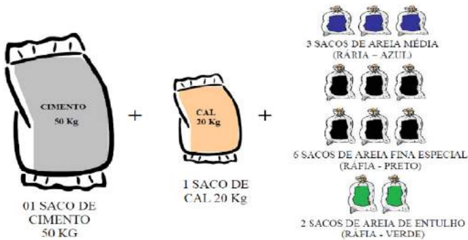
Figura 54 – Britador portátil usado para viabilizar reciclagem na obra. Por ser um britador de impacto com tela na saída, areia reciclada cimentícia e mista era produzida. O uso do material era para argamassas de assentamento, e/ou revestimento. Fonte: SINDUSCON-SP [31]. A ilustração abaixo é do traço usado na argamassa reciclada em obra. Fonte: Alexandre Brites (palestra dado no curso de Eng Civil da Poli USP)
