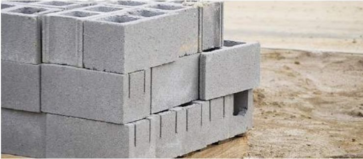
Figura 58 - Bloco de vedação cimentício pré-fabricado. Esse material é produzido com um tipo de concreto vibroprensado e compactado em condição úmida, mas seca.
