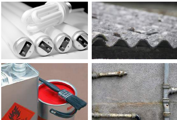
Figura 1 - Resíduos perigosos que podem estar presentes nos resíduos de construção. Lâmpadas contendo mercúrio (superior, à esquerda), amianto (superior, à direita), tintas líquidas contendo solventes (inferior, à esquerda) e tubulações de chumbo (inferior, à direita). Fontes das imagens: https://www.pensamentoverde.com.br/reciclagem/como-funciona-reciclagem-de-lampadas-fluorescentes/ | https://merryhill.co.uk/asbestos-removal-services/asbestos-encapsulation/ | https://www.mtu.edu/ehs/documents/flammable-storage/ | https://www.brothersplumbing.ca/blog/lead-pipe-replacement/often-get-lead-pipe-replaced/
