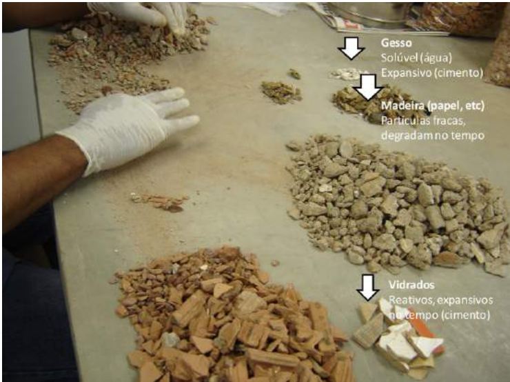
Figura 44 - Classificação dos materiais presentes nos agregados reciclados pelo ensaio de catação. O método só é aplicado na fração gráuda (acima de 4,8 mm).
