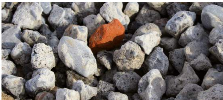
Figura 45 - Agregado reciclado de concreto contém poucos materiais secundários (como cerâmica vermelha, ou contaminantes). A partícula contém uma parcela menor de cimento endurecida, sendo constituído em grande parte por agregados (rochas) naturais.
