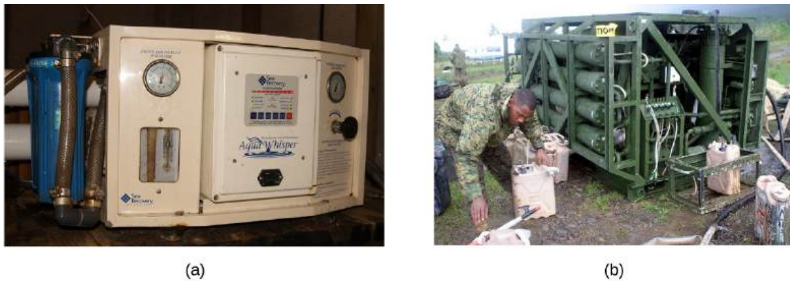
FIGURA 11.26 Los sistemas de ósmosis inversa para purificar el agua potable se muestran aquí en (a) pequeña y (b) gran escala (créditos: a: modificación del trabajo de Jerry Kirkhart; b: modificación del trabajo de Willard J. Lathrop).
