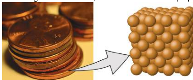
FIGURA 2.2 Un centavo de cobre anterior a 1982 (izquierda) contiene aproximadamente 3 \times 10^{22} átomos de cobre (varias docenas se representan como esferas marrones a la derecha), cada uno de los cuales tiene las mismas propiedades químicas (créditos: modificación del trabajo de "slgckgc"/Flickr).
