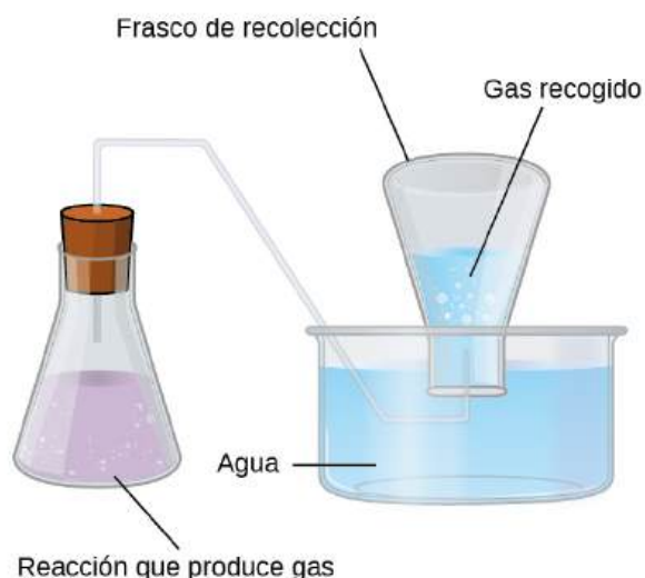
FIGURA 9.21 Cuando una reacción produce un gas que se recolecta sobre el agua, el gas atrapado es una mezcla del gas producido por la reacción y el vapor de agua. Si el matraz de recolección se coloca adecuadamente para igualar los niveles de agua tanto dentro como fuera del matraz, la presión de la mezcla de gas atrapada será igual a la presión atmosférica fuera del matraz (consulte la discusión anterior sobre los manómetros).
