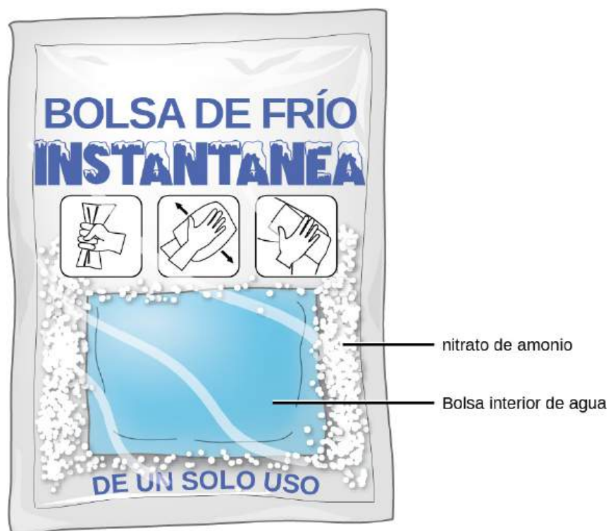
FIGURA 11.5 Una bolsa de frío instantánea se enfría cuando ciertas sales, como el nitrato de amonio, se disuelven en el agua, un proceso endotérmico.
