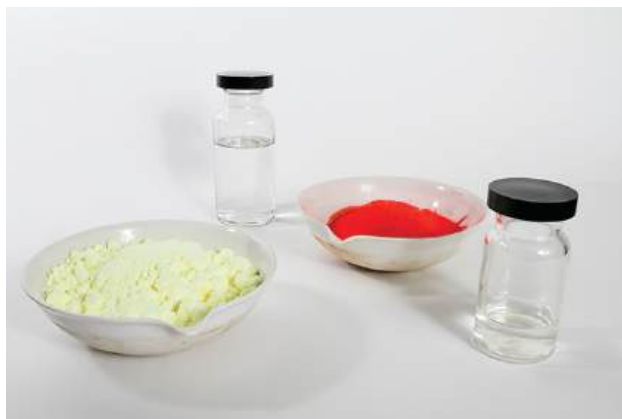
FIGURA 3.6 Cada muestra contiene 6,02 \times 10^{23} moléculas o unidades de fórmula-1,00 mol del compuesto o elemento. En el sentido de las agujas del reloj desde la parte superior izquierda: 130,2 g de \text{C}_8\text{H}_{17}\text{OH} (1-octanol, fórmula de masa 130,2 u), 454,4 g de \text{HgI}_2 (yoduro de mercurio(II), fórmula de masa 454,4 u), 32,0 g de \text{CH}_3\text{OH} (metanol, fórmula de masa 32,0 u) y 256,5 g de \text{S}_8 (azufre, fórmula de masa 256,5 u) (créditos: Sahar Atwa).
