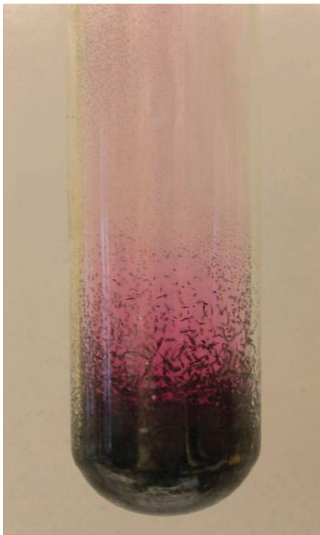
FIGURA 10.27 La sublimación del yodo sólido en el fondo del tubo produce un gas púrpura que posteriormente se deposita como yodo sólido en la parte más fría del tubo superior (créditos: modificación del trabajo de Mark Ott).
