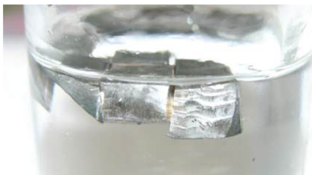
FIGURA 18.3 El litio flota en el aceite de parafina porque su densidad es menor que la del aceite de parafina.
