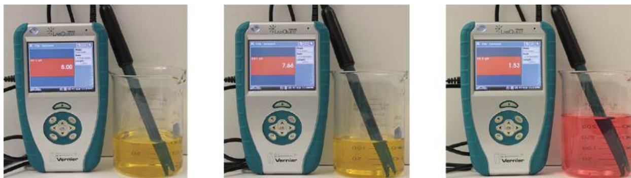
FIGURA 14.16 El color del indicador (naranja de metilo) muestra que una pequeña cantidad de ácido añadida a una solución tamponada de pH 8 (vaso de precipitados de la izquierda) tiene poco efecto en el sistema tamponado (vaso de precipitados del medio). Sin embargo, una gran cantidad de ácido agota la capacidad tampón de la solución y el pH cambia drásticamente (vaso de precipitados de la derecha) (créditos: modificación del trabajo de Mark Ott).
