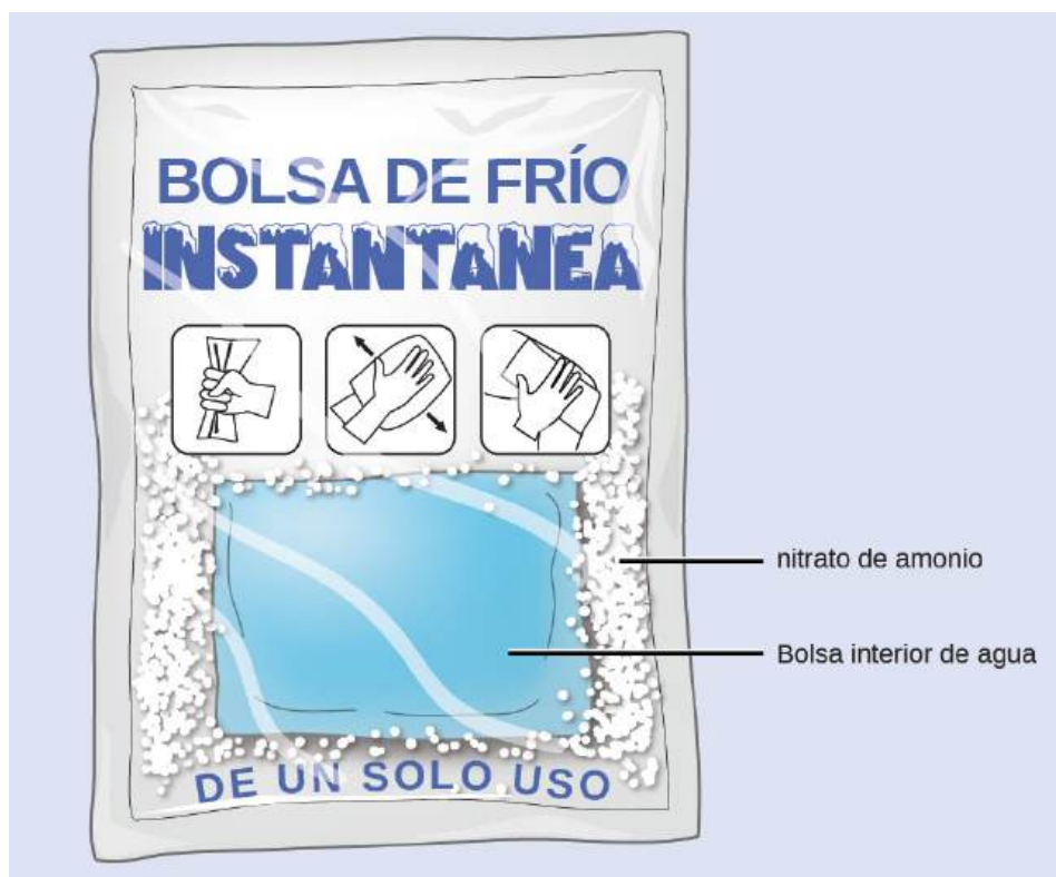
FIGURA 5.16 Una bolsa de frío instantáneo consiste en una bolsa que contiene nitrato de amonio sólido y una segunda bolsa de agua. Cuando se rompe la bolsa de agua, la bolsa se enfría porque la disolución del nitrato de amonio es un proceso endotérmico que elimina la energía térmica del agua. A continuación, la bolsa fría elimina la energía térmica de su cuerpo.
