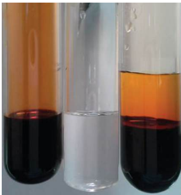
FIGURA 11.15 El bromo (el líquido naranja intenso de la izquierda) y el agua (el líquido claro del centro) son parcialmente miscibles. La capa superior de la mezcla de la derecha es una solución saturada de bromo en agua; la capa inferior es una solución saturada de agua en bromo (créditos: Paul Flowers).
