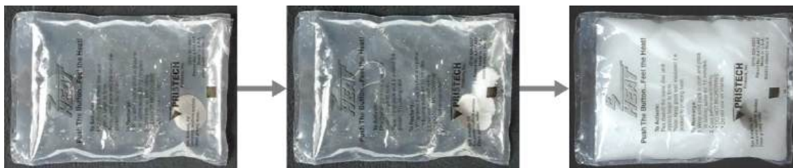
FIGURA 5.15 Los calentadores de manos químicos producen calor que calienta la mano en un día frío. En esta, se puede ver el disco metálico que inicia la reacción de precipitación exotérmica (créditos: modificación del trabajo de Science Buddies TV/YouTube).
