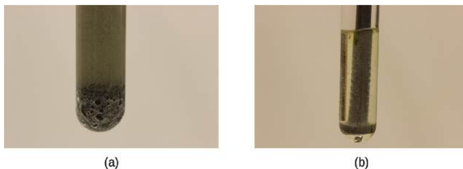
FIGURA 12.6 (a) El polvo de hierro reacciona rápidamente con el ácido clorhídrico diluido y produce burbujas de gas hidrógeno: 2\text{Fe}(s) + 6\text{HCl}(aq) \rightarrow 2\text{FeCl}_3(aq) + 3\text{H}_2(g) . Un clavo de hierro reacciona más lentamente porque la superficie expuesta al ácido es mucho menor.
