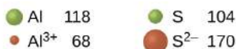
FIGURA 6.32 El radio de un catión es menor que el del átomo padre (Al), debido a los electrones perdidos; el radio de un anión es mayor que el del padre (S), debido a los electrones ganados.
