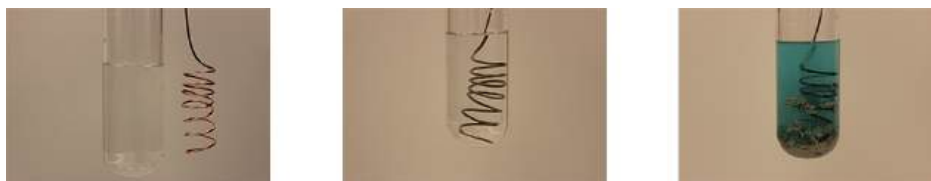
FIGURA 17.2 Un alambre de cobre y una solución acuosa de nitrato de plata (izquierda) se ponen en contacto (centro) y se produce una transferencia espontánea de electrones, creando \text{Cu}^{2+}(aq) azul y \text{Ag}(s) gris (derecha).
