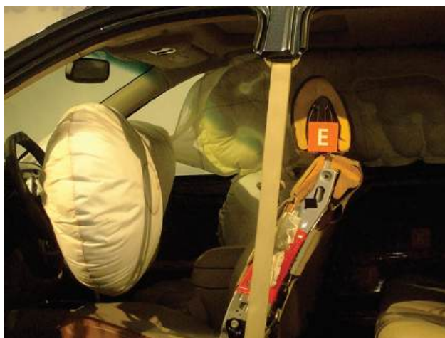
FIGURA 4.12 Los airbags se despliegan en el momento del impacto para minimizar las lesiones graves de los pasajeros (créditos: Jon Seidman)
