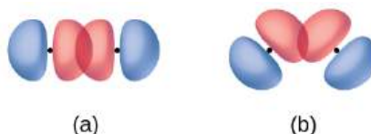
FIGURA 8.3 (a) La superposición de dos orbitales p es mayor cuando estos van de extremo a extremo. (b) Cualquier otra disposición da lugar a una menor superposición. Los puntos indican la ubicación de los núcleos.
