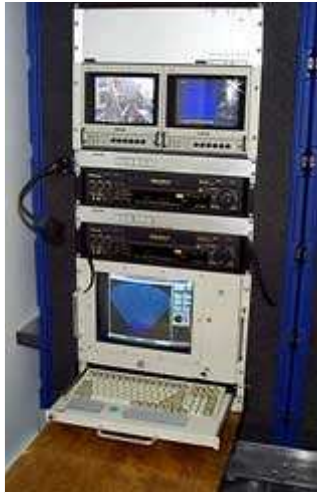
Copiloto sonar y vídeo consola con dual multi estándar VCR's y 8x video distribución con multi switcher con VGA video convertidor y audio mezclador.
