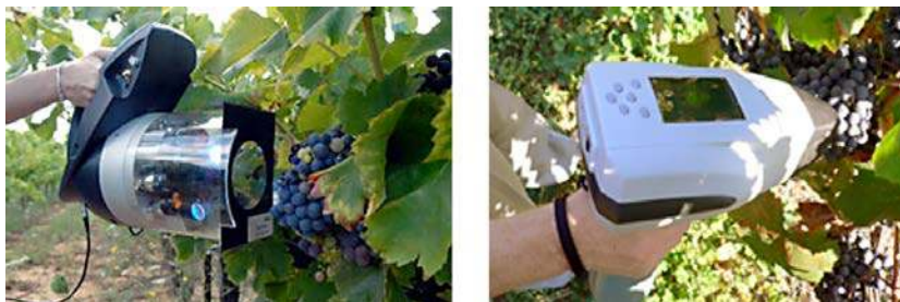
Figura 15. Equipo de medición de calidad de fruta NIR y sensor de Multiplex UV.
