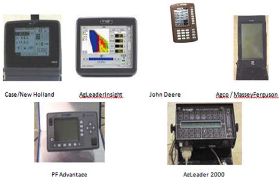
Figura 1: Monitores de rendimiento más difundidos
