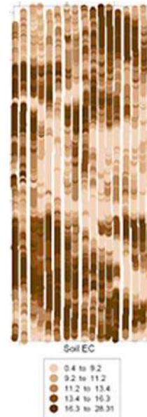
Figura 6. Un mapa de medidas de conductividad de los suelos tomadas con un sistema de carro de conductividad eléctrica que muestra la variabilidad de la conductividad eléctrica del suelo dentro del campo
