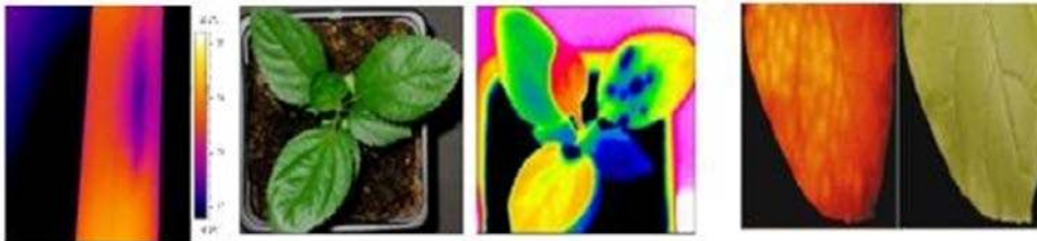
Figura 7. Detección de problemas fungos e virales en vegetación mediante Visión Artificial
