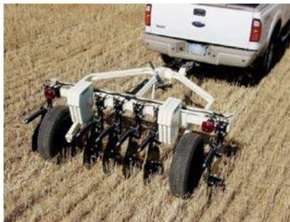
Figura 4. Un carro de conductividad eléctrica usado en un campo de trigo cosechado para medir la conductividad eléctrica del suelo. Sitio web: www.veristech.com
