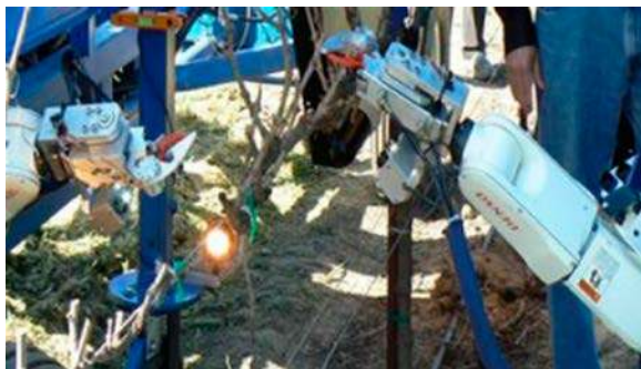
Figura 18. Brazos robóticos del Robot podador de viñedos
