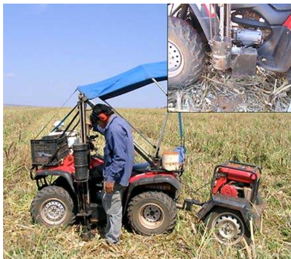
Figura 4. Muestreador hidráulico tipo broca (foto pequeña) montado en cuatriciclo, equipo comúnmente utilizado en el muestreo georreferenciado del suelo. El GPS es el dispositivo de color blanco acoplado en frente del vehículo, al lado de la caja de almacenamiento de muestras. (Fotos: Álvaro Resende)
