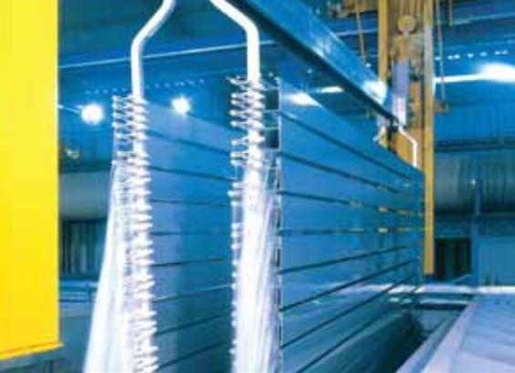
Figura 21 - Perfis de alumínio sendo anodizados
