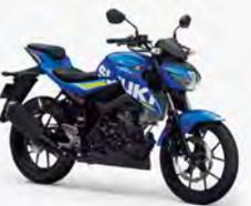
水冷DOHC単気筒エンジン、フレームやサスはGSX-R125をベースにしているが、ワイルドな雰囲気な仕上げたネイキッドスタイルに印象を大きく変えている。
