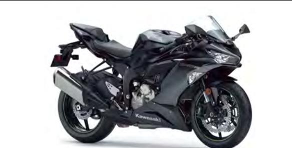
ZX-6Rが徐々にモデルチェンジを受け国内発売。フレームやエンジンなどは従来モデルがベースだが、LEDヘッドライトを採用した新スタイリングとなり、さらにKQS(カワサキイックシフター)、KTRC(カワサキトラクションコントロール)、パワーモードなど最新のライダーサポート技術を搭載。国内仕様はETC2.0も標準装備する。
