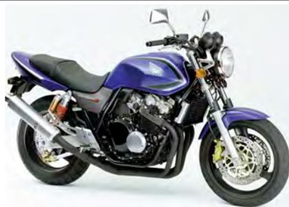
この年のマイナーチェンジでは、ハイパーVTECスペックⅡのバルブ切り替えタイミングを変更することで、中速域でのパワー特性の向上を図ったのが最大のポイント。フォークにカバーが追加され、ボトムケースも変更、サスセッティングも見直された。盗難対策に有効なH-I-S-Sが400ccクラスで初採用されたのもこのモデル。
