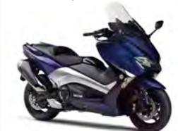
TMAX530がモデルチェンジ。電子制御スロットルを採用したエンジンと、新設計のアルミフレームにリンク式リアサスを組み合わせた車体を採用。スタンダード仕様のSX、装備を充実させたDXを設定。
