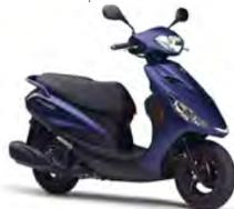
静粛かつ振動の少ないエンジン始動をもたらすSMGを装備するとともに最新の排出ガス規制に適合。リアブレーキ操作でフロントもバランスよく効かせるUBSの採用するほか、ヘッドランプの光量をアップ。
