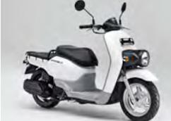
50ccビジネススクーターのベンリィ/プロがモデルチェンジ。水冷eSPエンジンの採用に加え、実用性やメンテナンス性がさらに向上している。
