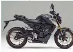
モダンなスタイリングと250譲りの車体が魅力の125ccスポーツ。CB125Rがモデルチェンジ。新たに水冷シングルエンジンをDOHC化し、倒立フロントフォークもSFF-BPタイプを採用。走りの質をグレードアップ。
