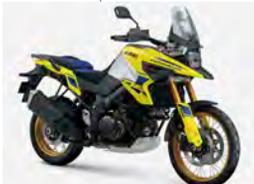
Vストローム1050をベースに、フロントに21インチホイールを装着し、セミブロックパターンのタイヤ、幅広いハンドルを装備し登場した1050DE。トラクションコントロールシステムには専用のGモードも設定される。
