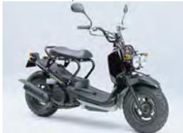
アルミモジュールフレームにスチールフレームを組み合わせ、クリーンな水冷4ストエンジンを搭載。シート下をフリースペースとしたユニークなモデル。
