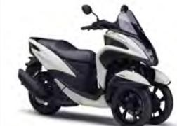
独自のLMW機構により、三輪レイアウトながら二輪同様の旋回性と、三輪ならではの高い安定性を兼ね備える125ccスクータートリシティ125。2021年モデルでは新色のイエローがボディカラーに追加された。
