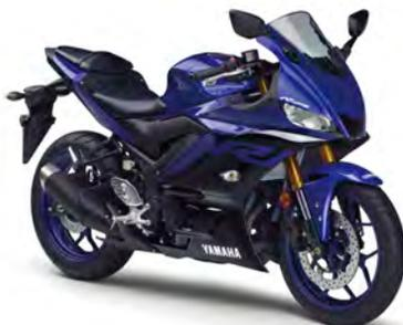
毎日乗れるスーパースポーツとして根強い人気を集めているYZF-R25が、初めて大規模なモデルチェンジを受けた。フロントマスクをはじめ、スタイリングは最新のMotoGPマシン・YZR-M1を想わせる新デザインになり、LEDヘッドライトも採用。フロントフォークは倒立タイプとなり、快適性とスポーツ性をハイレベルで両立させている。
