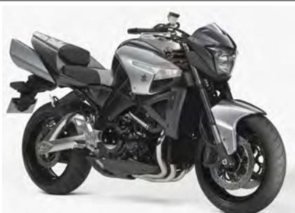
2001年の東京モーターショーで注目されたB-KINGのコンセプトを具現化。超個性的なスタイルにハヤブサの直4を搭載したネイキッドモデルで、出力特性を切り替えるS-DMSも採用している。
