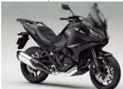
カラーバリエーションとしてガンメタルブラックメタリックを新たに設定。継続色のマットイリジウムグレーメタリックとあわせて全2色の設定とした。また、マフラーの外観仕上げはヘアライン仕上げに変更。
