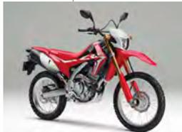
スロットルボディの口径を大径化するとともに、マフラーの変更などで改良。フルデジタルメーターも装備している。ローダウン仕様のタイプLDも設定。
