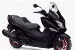
スカイウェイブ400の後継としてデビュー。流麗なスタイルのボディはスカイウェイブよりも軽量で、フロントホイールを15インチに大径化している。
