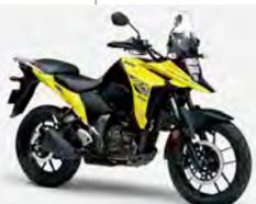
油冷単気筒エンジンを搭載し、フロントには19インチホイールを採用したスポーツクロスオーバーモデルVストローム250SX。高い防風性のウインドスクリーン、ナックルカバーなど装備も充実する。
