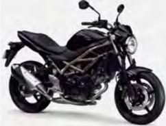
強力な645ccVツインエンジンを搭載する、ベーシックなミドルネイキッドのSV650に2021年モデルが登場。メカニズムについては従来モデルのものが受け継がれていて、カラーリングのみが変更された。
