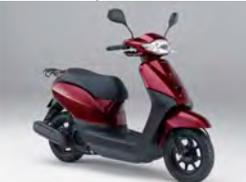
タクトの名を冠したスクーターが久々に復活。コンパクトで実用的な造りのボディに、タンクにも採用された50cc版水冷eSPエンジンを搭載。
