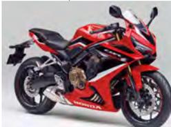
CBR650Rがモデルチェンジを受け、フロントフォークをショーワ製SFF-BPとしてハンドリングを改善。シートカウルなどスタイリングもリファイン。カラーリングも変更されている。
