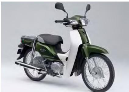
スーパーカブ50が46年ぶりにフルモデルチェンジ。外装デザインをはじめ、パイプアンダーボーンフレーム+樹脂製外装ボディ、二段クラッチを採用した新型エンジン、フロントサスのテレスコピックフォーク化など、スーパーカブ110と共通した設計に。中国で生産することで価格も引き下げられた。
