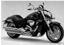
ブルバードM109Rから、スタイルの大きな特徴であるビキニカウルを取り去り、異形ヘッドライトを流して精悍なイメージでまとめたネイキッドバージョン。
