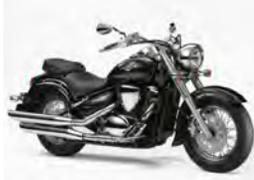
重厚なレックスのVツインエンジンにシャフトドライブ。スタンダードモデルではワイヤースポークホイールを装着。新たにフューエルインジェクションを採用して排出ガス規制に対応。
