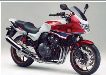
トータルバランス抜群なCB400SFの双子モデルで、ハーフカウルを装備したCB400SBもモデルチェンジ。平成28年度排出ガス規制対応、パワーアップ、前後サスペンションの改良によるハンドリングの改善などはCB400SFと共通。CB400SBは全車ABSが標準装備なのがCB400SFとは異なっている。
