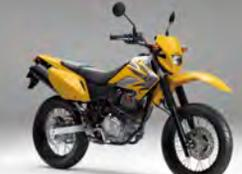
トータルバランスの良さとオフロードで優れた走破性を発揮するXR230をベースに、前後ホイールを17インチに換装したモタード仕様。
