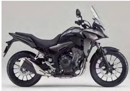
モデルチェンジでスタイリングを変更すると同時に、フロントホイールを19インチ化して走破性の向上を図った。
