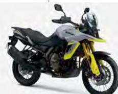
フロント21インチホイールを採用し、2軸1次バランススズキクロスバランサーを採用した775cc並列2気筒エンジンを搭載したスポーツアドベンチャーツアラーVストローム800DE。
