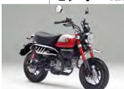
モンキー125が初めてモデルチェンジ。スタイリングや車体の基本構成はそのままで、グロムにも搭載されたロングストロークエンジンや、5速ミッションを新たに採用している。
