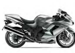
フルブーストで200PSオーバーのメガスポーツに新たにABS仕様が増加された。外觀デザインに変更はないが、2008年型は最高出力が193PSにアップ。
