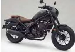
人気の新世代クルーザーレブル250がモデルチェンジ。灯い類を全てLED化し、アシストスリッパークラッチも装着。Sエディションはピキニカウルや専用シートなどを装着する。
