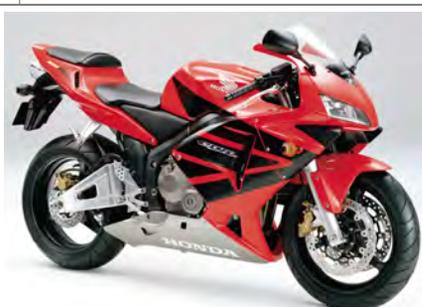
センターアップマフラーやユニットプロリンクなど、車体からエンジンまでRC211Vの技術も注して開発された、ミドルスーパースポーツ。国内仕様は日本の規制にに合わせて最高出力は69PSとされているが、スポーティな乗り味は損なわれていない。
