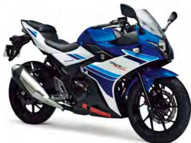
GSX250Rはスーパースポーツのようなレーシーなフルカウルを装備しているが、その開発コンセプトは日常的な扱いやすさを持つスタイリッシュでスタンダードなストリートスポーツ。GSXRベースの248cc水冷並列2気筒エンジンは街乗りで多用する低中速の扱いやすさを重視、セパハンを採用しなからも快適なポジション設定も備えている。
