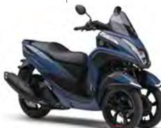
フロント2輪のLMWモデルトリシティ125/150ABSが平成32年排出ガス規制適合の新ブルーコアエンジンを採用し新フレーム、ロングホイールベース化で上質な乗り味になってモラルチェンジ。
