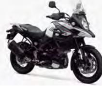
モデルチェンジで650と共通イメージのスタイルを採用。メカニズム面ではIMUを新搭載し、モーショントラックブレーキを実現。スポークホイール仕様のXTも新たに用意された。
