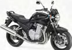
国内市販のビッグネイキッドとして安定した人気を博したバンディット1200がモデルチェンジ。ハーフカウルを装備するS、そしてカウルレスのネイキッド版とともに油冷時代のものをベースとする車体に新設計の水冷ユニットを採用。ABSも標準装備する。
