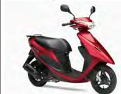
新型FI採用によって低燃費を実現したSEPエンジンを採用。スタイリングなどは従来モデルのままで、タンク容量もレッツのように従来の4.5Lから4.8Lへと増量。
