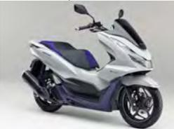
従来型PCXにあったPCXハイブリッドの後継モデル。新型PCXをベースに、リチウムイオンバッテリーと、ACGスターター(起動アシスト機能も担わせるハイブリッドシステムを搭載する。
