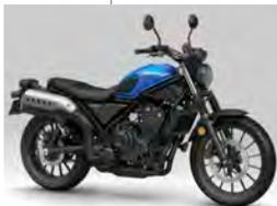
CL250iに続き登場したCL500。レブル500で高い評価を得るDOHC2気筒エンジンには、アシスト&スリッパークラッチを採用。カジュアルな印象のグリントゥエーブブルーメタリック、タフな印象のマットアーモンドグリーンメタリックの2色がラインアップ。
