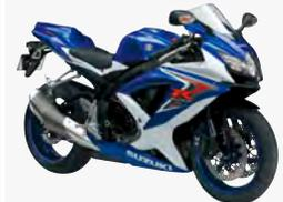
2008年モデルは、FIのインジェクターの小型化により、1シリンダーあたり2インジェクターを採用。また3種類の出力特性を選択できるS-DMSも搭載された。
