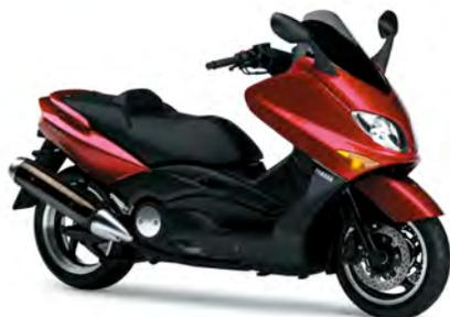
エンジンはFI化でトルクアップ。フロントフォーク強化、Fブレーキのダブルディスク化、リアホイール15インチ化、ラジアルタイヤ採用など、足まわりが大きく進化している。
