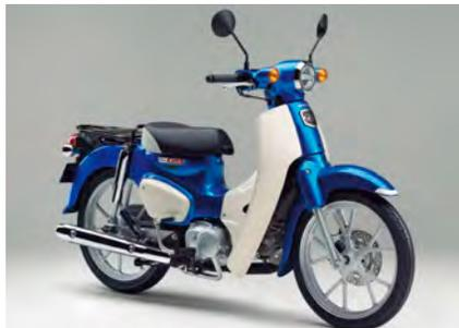
新エンジンを搭載するとともに、ABS付きのフロントディスクブレーキや前後キャストホイールとチューブレスタイヤを採用してモデルチェンジ。メーター内には新たにギアポジションや時計などが新たに用意された。
