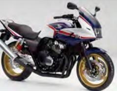
2006年モデルでは低回転域での扱いやすさをアップするためイグニッションコイルを大型化。スモーククリアのウインカーレンズを前後に採用する。
