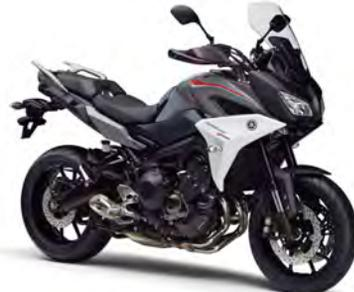
MT-09から派生したスポーツツアラー、トレーサー900がモデルチェンジ。定評のあったスポーツ性はそのまま、快適な乗り心地とツーリング機能を強化するため、防風性能を高めた新型フロントスクリーンをはじめ、新し前後シート、サイドケース用マウント追加、60mm延長されたスイングアームなど大改良を受けた。
