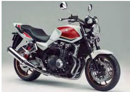
伝統と最新技術をミックスしたCBシリーズの最高峰モデルで、根強い支持を集め続けるCB1300SF。今回のモデルチェンジで、丸形LEDヘッドライトの採用などスポーティで堂々たるネイキッドスタイルをリファイン。排ガス規制をクリアしつつ9PS/パワーアップされた水冷直4エンジンは、アシストスリッパークラッチも装備。
