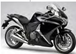
二輪車用としては世界初の有段式自動変速機・DCTを搭載。ハンドルのスイッチでクラッチ操作なしでのマニュアルシフトも可能。
