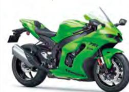
レース向けのベースモデルとして設定されるZX-10RRもZX-10Rと同時にモデルチェンジ。シングルシートやマルカジーニ製ホイールが装着され、チタンコントロールや専用カムが組まれたRR専用エンジンを搭載。
