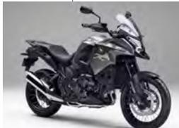
ホンダのアドベンチャーツアラーVFR1200Xの国内仕様。車名の通りVFR1200Fと基本メカニズムを同じくし、DCTやABSなど装備も充実。
