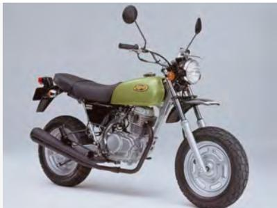
50ccだったエイプに、パワフルなXR100系の99cc空冷シングルエンジンを搭載。軽快な走りで4ミニブームの大きなきっかけとなった。エンジン以外にも、ロングシートとタンデムステップが装備され、フレームやリアホイールも強化されていてタンデムが可能。カラーオーダープランも設定されていた。
