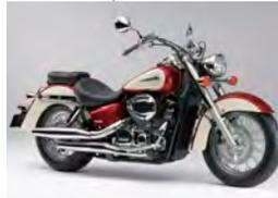
エンジンをPGM-FI化。マフラーにキャタライザーを内蔵するなど、平成19年国内二輪車排ガス規制に適合。ハンドルの形状見直しなど、各部を大幅に改良。
