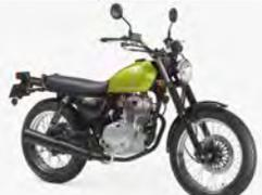
グラストラッカーをベースに前後タイヤのインチアップや幅広いハンドルなどを装着したビッグボーイがFI仕様で登場。始動はセルのみで、燃料タンク容量が2L拡大した。
