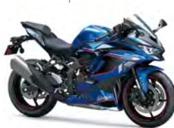
77PSを発揮する新設計の水冷4ストDOHC4バルブ並列4気筒エンジンを搭載した、400ccスーパースポーツZX-4R SE。SHOWA SFF-BPフロントサスペンション、KTRC、KQSなど充実の装備も魅力。
