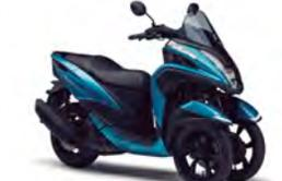
124ccブルーコアエンジンを搭載。4バルブ化するとともに、VVA機構を採用し最高出力を1PS向上。さらに、43.6km/Lという低燃費も実現。フレームも新設計。
