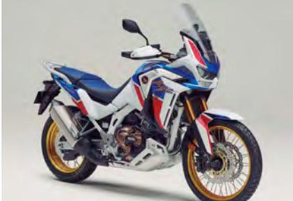
CRF1100Lアフリカツインへ、大容量燃料タンクや大型スクリーンといったハードな走りを可能とする装備を与えたアドベンチャースポーツ。このアドベンチャースポーツに、スピードや車体の状態に合わせて瞬時に減衰力を最適化できるショーワ製電子制御サス・EERAを装備したモデルがESだ。
