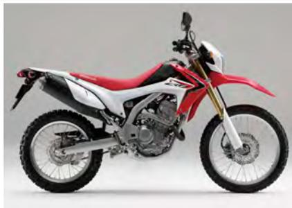
ホンダが国内向けに開発したスクタの250ccフルサイズオフローダー。CBR250R用単気筒エンジンをオフロード向けにリファインし、新設計のスチール製ソインチューブフレームに搭載。倒立フォークなどを組み合わせ、市街地からオフロードまで軽快な走りを楽しめる。CBR250Rと同様にタイで生産されている。
