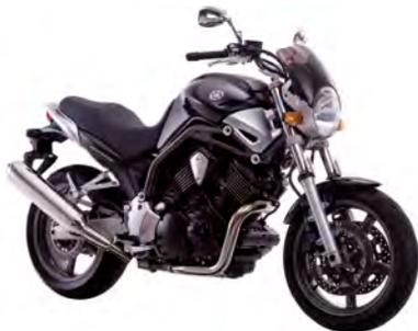
ドラッグスター1100系の空冷Vツインエンジンを吸気系への見直しでパワーアップしたものを、スチール製のツインチューブバックボーンフレームへ搭載したネイキッドスポーツ。生産はイタリアのベルガモネ・ヤマハが担当しているだけに、イタリアンデザインが光る美しいスタイルも魅力。
