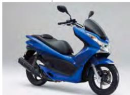
エンジンを改良し、耐久性と静粛性、燃費性能をさらに追求した新型のeSPエンジンを搭載。シート形状など細部も熟成され、さらに使いやすく進化した。
