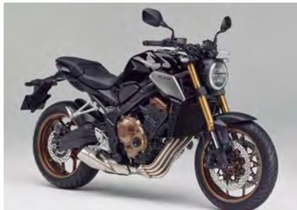
CB650Fの後継モデルとして登場。CB1000Rと共通な凝縮感のあるカフェレーサーのスタイルに一新。LEDヘッドライトも採用。フレームも一新され軽量化と同時に剛性/バランスも改善し、より軽快で上質な乗り味に。エンジンも扱いやすいトルク特性を備えつつ高回転での出力を向上し、アシストスリッパークラッチやセレクトダブルトルクコントロールも装備。
