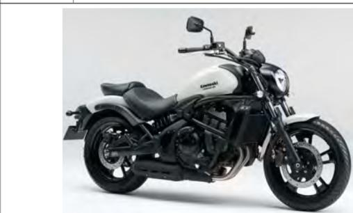
カワサキのクルーザーとして長年親しまれてきたバルカンシリーズは、2007年以降水冷Vツイン搭載の900系のみだったが、久々にニューモデルのバルカンSが登場。ER-6系の水冷並列2気筒エンジンを新たにデザインされたモダンで個性的な車体に搭載。街乗りからツーリングまで、多彩なニーズにフィットできるアーバンランナーだ。
