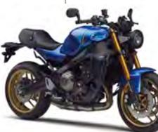
ヤマハレーシングヘリテージを反映した新スタイルに変更。エンジンは888ccへと排気量アップし、軽量新フレームと軽量ホイールを採用した車体に搭載。IMUを活用し運転操作を支援する各種制御も装備。
