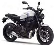
XSR700 ABSがマイナーチェンジして平成32年排出ガス規制適合化。新タイヤの採用とフロントブレーキディスクの大径化、灯火類のLED化やネガポジ反転LCDメーターの採用などが行われた。
