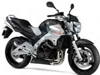
クラス初のアルミキャストフレームに、GSX-R600ベースのエンジンを搭載。輸出仕様の600は97PSを発揮。2006-2007年グッドデザイン受賞車でもある。
