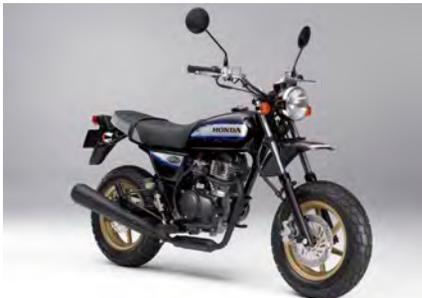
キャタライザーなどの採用で排ガス規制をクリアすると同時にバッテリーも装備したエイプ100の前・後ホイールをアルミキャストホイールとし、さらにディスクブレーキも装着したスポーティバージョン。
