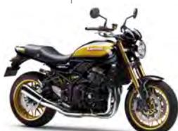
Z900RSのハイグレードモデルとして発売されるZ900RS SE。フレンド社製のフロントブレーキ、オーリンズ製のハイグレードリヤショックを装備し、専用カラーを採用。2023年モデルからの変更点はなし。
