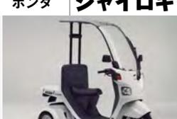
平成28年排出ガス規制に対応。新たにリアファンダーの左側にエンジンオイルの点検・交換時に役立つ開閉式の点検窓を設置しメンテナンス性を向上している。
