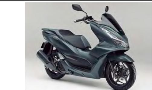
エンジンをはじめ、全てを一新してフルモデルチェンジされたPCXの軽二輪バージョン。エンジンの排気量を156ccに拡大し、PCXより3.3PS/パワーアップして高速走行に対応。
