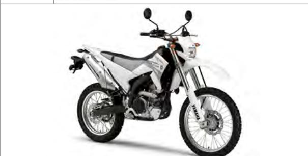
「オフロードのR1」を目指して開発されたモデル。専用設計のDOHC4バルブ水冷単気筒に、国産市販オフロードモデル初のアルミフレームなどで高性能を実現。
