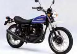
フェーエルインジェクションを採用してモデルチェンジ。また、ハンドル左右幅を30mm短縮させ、乗りやすさを向上させている。
