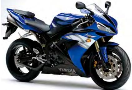
剛性をアップしたデルタボックスVフレームを新設計。エンジンも新ユニットで最高出力が172PSにアップし、ブレーキにはラジアルマウントキャリパーを採用。
