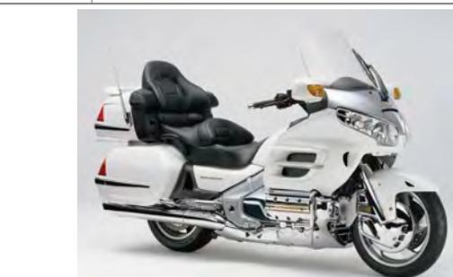
ゴージャスなラグジュアリーツアラーのゴールドウイングが13年ぶりに全てを一新してフルモデルチェンジ。フラット6エンジンは1800ccまで排気量拡大、軽量で剛性も高い新設計のアルミフレームも採用。
