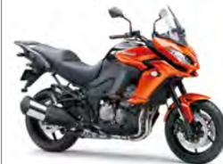
2015年モデルで初のモデルチェンジ。フロントマスクに、ロードスポーツ風デュアルヘッドライトを備えた、ニンジャ1000を思わせるデザインに変更。
