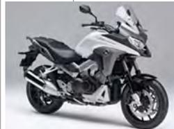
VFR800Xがモデルチェンジ。中低速で力強さを増したエンジンやトラクションコントロール採用のほか、LEDライトやヒートクリップなどの装備も充実化。
