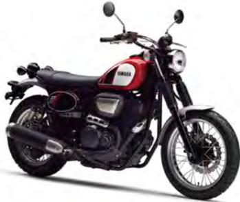
スポーティなクルーザーのポリティをベースに、70年代風の軽快なスクランブラースタイルに変身させたのがSCR950。空冷Vツインエンジンなどはポリティとほぼ共通だが、リア周りのフレームの改良、サスペンションの変更やスポークホイール化、ブロックパターンのタイヤを装着してフラットダートならば苦もなく走れる。
