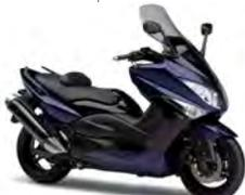
前後タイヤを15インチ化し、ラジアルタイヤを採用したTMAXの二代目。アルミフレームの採用やエンジンのリセッティングなどでパフォーマンスを大幅に向上させている。
