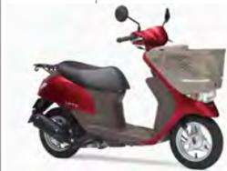
レッツバスケットも新エンジンを搭載。さらに燃料タンク容量もレッツと同様に4.5Lから4.8Lへと増やされて最大航続距離も伸ばされている。
