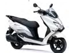
ラグジュアリースクーターとして登場したバーグマンストリート125EX。停車時にエンジンを自動的に停止させるアイドリングストップシステムや、静かに始動させるサイレントスターターシステムが組み込まれたSEP-αエンジンを搭載。
