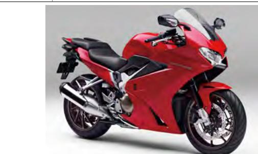
フレームは先代のVFRがベースだが、サイドに配置されていたラジエーターをエンジン前に移すことで実現されたシャープなフルカウルで大幅にイメージチェンジ。ハイパーVTEC機構を備えるV4エンジンも吸気系の改良で力強さを増し、トラクションコントロールも装備。この国内仕様は受注生産モデルで、ETC車載器とグリップヒーターを標準装備。
