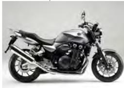
CB1300SFがモデルチェンジ。6速ミッション化、新型ホイールの装着、新設計のメーターなど多岐にわたる変更で熟成度をアップ。
