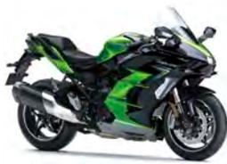
スーパーチャージドエンジンによる究極の性能と、ロングツーリングのための快適性を追求したモデル。SEはKECSを搭載し、路面やライディング状況に合わせ瞬時に減衰力を最適化するなどした上級版。
