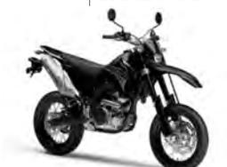
WR250Rをベースとした本格モタードスポーツ。クラス初のアルミフレームや前後17インチのロードタイヤを装着し、31PSの高出力を絞り出す。
