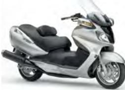
国産スクーターでは最大排気量を誇るエンジンで、快適装備を満載した巨体を軽々と走らせるツアラー的ビッグスクーター。クラス初の電子制御CVTミッションは、有段式のマニュアル変速操作も可能。
