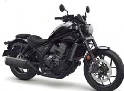
250ccクラスで人気のレブルのコンセプトを、ビッグクルーザーに取り入れたニューモデル。エンジンはアフリカツイン系の1082cc並列ツイン。DCT仕様先行して発売された。
