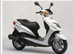
新開発の4バルブ&メッキシリンダー採用の125ccエンジン、安定性の高い12インチホイールを履くボディに搭載。スポーティなスタイルで実用性も高い。
