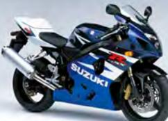
750とともにこの年フルモデルチェンジ。激化する600ccクラスのレースに対応して、ニューエンジンと倒立フロントフォークなどで戦闘力を向上。
