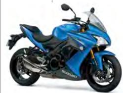
GSX-S1000Iに高速走行での快適性を重視したフルカウルを装備した万能モデル。ネイキッドのGSX-S1000同様トラクションコントロールも採用。
