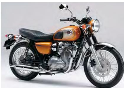
W650の後継モデル。端正でクラシカルなスタイリングはW650から大きな変更はされていないが、エンジン排気量をアップするとともにフューエルインジェクション化。細部のリアフィンと仕上げの向上により美しさにも磨きがかかった。
