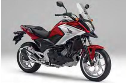
NC750Xが初のモデルチェンジ。LEDヘッドライトを採用してスタイリングを一新し、タンク部のラゲッジボックスの大型化など実用性も大きく向上。エンジンは細部にわたる熟成を図り扱いやすさを増し、DCTの制御プログラムも変更して完成度もアップ。フロントフォークなど足まわりにも手が入り、乗り心地とハンドリングも改善された。
