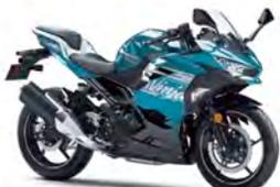
ニンジャ250の車体に、パワフルな398ccエンジンを搭載したモデルがニンジャ400。特別仕様車のKRTエディションも含め、新デザインのグラフィックに変更。
