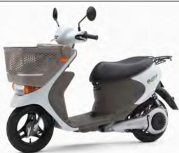
ホイールレイン電気モーターとリチウムイオン電池を使った排気ガスゼロの電動スクーター。車体のベースとなったのはレッツ4i/バスケット。Wはもうひとつバッテリーが追加される。
