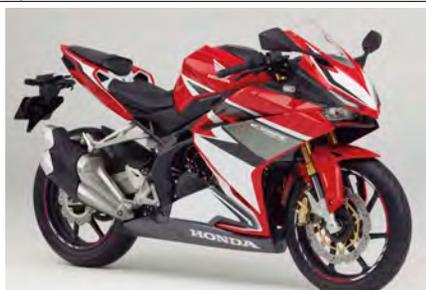
ホンダファン待望の最新250ccスーパースポーツ。新開発の水冷並列2気筒エンジンは、最高出力38PSと国内クラス最高のVツワーを発揮。鋼管トラスフレームに倒立フォークを組み合わせた車体でシャープなハンドリングも実現。LEDヘッドライトを活かした先鋒的なフルカウルスタイルも魅力的だ。
