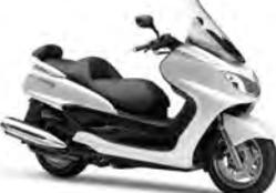
バックレスト一体型によるフィット感に優れた新シートを採用をはじめ、タンデムライダー用バックレストの追加、リアサスの調整機能追加などの改良を受けた。
