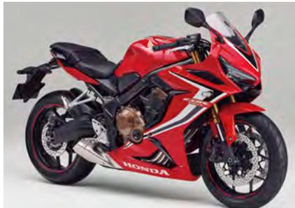
CBR650Fから“操る楽しみ”を狙いフルモデルチェンジ。LEDライトを活かした新デザインのフルカウルで一新。剛性バランスを見直した新フレームを中心に、軽量化とマスの集中化を進めた車体に倒立フォークなどを組み合わせた運動性能も向上。エンジンもフレキシブルさと高回転での力強さを両立。アシストスリッパークラッチで快適でスムーズな乗り味に。
