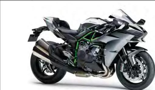
カワサキの技術の粋を集めたニンジャシリーズの最高峰。新設計の1000cc水冷直4を専用開発のスーパーチャージャーで過給するエンジンを搭載。ハイパワーに動じない安定性とシャープなハンドリングを両立するスチール製トレリスフレームは、ピボットレス構造も採用。スイングアームはカワサキ車初となる片持ちタイプ。
