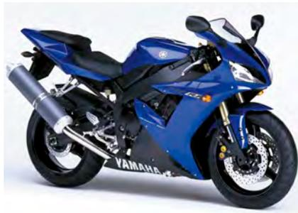
98年の初代から数えて三代目となる02年型。エンジンへの燃料供給をキャプテナーからサクシヨナルバルブ付きフューエルインジェクションに変更、さらに2軸式EXUPも採用しエンジンはさらに強力に。フレームの剛性バランス改善、フロントフォークの大径化、スイングアームの変更など、車体も大きく進歩した。
