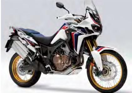
90年代に人気を集めた国産アドベンチャーツアラーの先駆けであるアフリカツインが、全てを一新したニューモデルとして復活。先代同様、道を選ばずどこへでも行けるモデルを目指し、新開発の998cc水冷並列2気筒エンジンなど、新技術を全身に取り入れて開発。オフロード走行にも対応したDCT搭載モデルも用意されるなど、快適性も非常に高い。
