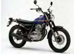
エンジンや車体は基本的にグラストラッカーと共通だが、ホイールを前19・後18インチと大径化して走破性を高めるとともに、車体をより大柄なイメージに見せている。
