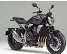
CBの伝統とモダンなディテール、メカニズムを融合させたCB1000Rがヘッドライト等の外観をリファインし、シートレールやリアフェンダーもスリム化。スマートフォンとの連携を可能とするHSVCSも搭載された。
