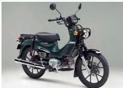
最大トルクと燃費性能の向上を図りながら最新の排出ガス規制に対応した新エンジンを搭載。ABSを採用したフロントディスクブレーキと、前後キャストホイールおよびチューブレスタイヤを新たに採用。
