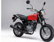
キャブセッティングの最適化とマフラーへのキャタライザー追加で国内二輪車排ガス規制をクリア。バッテリーも装備され、カラーリングも変更された。
