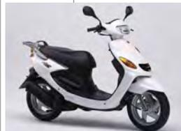
2ストローク・ケースリードバルブシングルエンジンなどの基本構成をそのままに、エアシュラウドの二重構造化や排ガス浄化装置の仕様変更により騒音を低減。外装関係ではフロントグリルのデザインを変更し、新色も採用。
