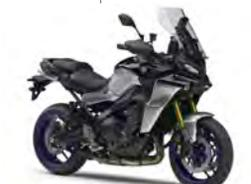
スポーツツアラーとして確固たる地位を確立するトレーサー9 GT+に、ヤマハから発売されるオートバイで初となるミリ波レーダーを活用したアダプティブクルーズコントロール、新型ユニファイドブレーキシテムを搭載された。
