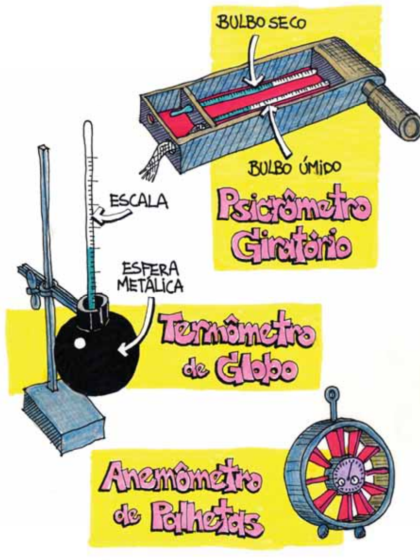
Figura 2-17: termômetro de globo, psicrômetro giratório e anemômetro
