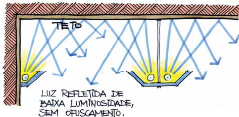
Figura 2-24: Iluminação indireta através do teto
