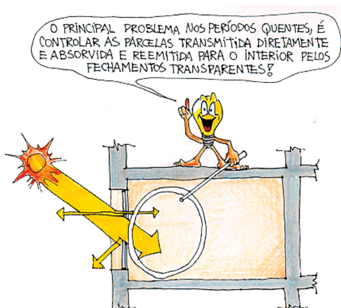
Figura 7-2: Radiação transmitida, absorvida e refletida pelo vidro
