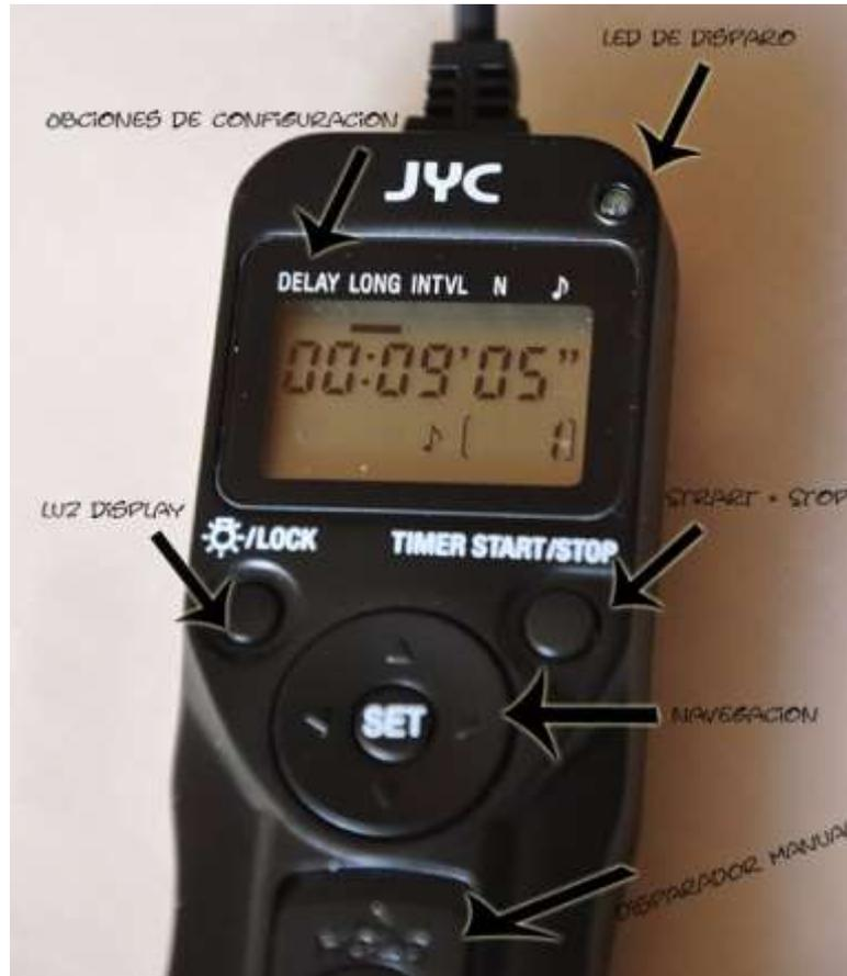
Este aparatito, nos va a permitir realizar fotografías sin la necesidad de tocar la cámara, y así evitar las posibles vibraciones que podamos transmitirla, esto en las disciplinas más corrientes. Para la nocturna, o para la fotografía de larga exposición, nos permitirá realizar las tomas olvidándonos de relojes, móviles y demás accesorios.
