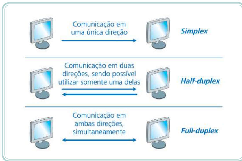
Figura 3.2: Diferenças entre modo de comunicação: simplex , half-duplex e full-duplex Fonte: CTISM, adaptado dos autores
