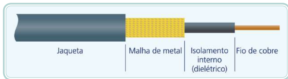
Figura 5.1: Partes do cabo coaxial
