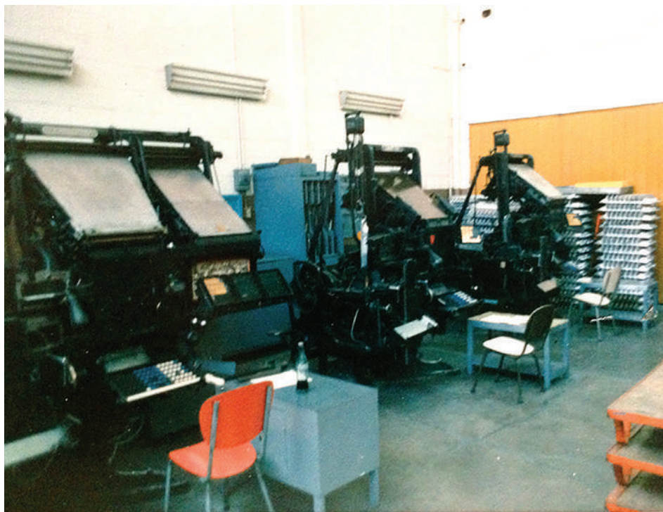
Imagen 2.11 Área de linotipos de la Imprenta Madero. Archivo fotográfico José H. Azorín.
