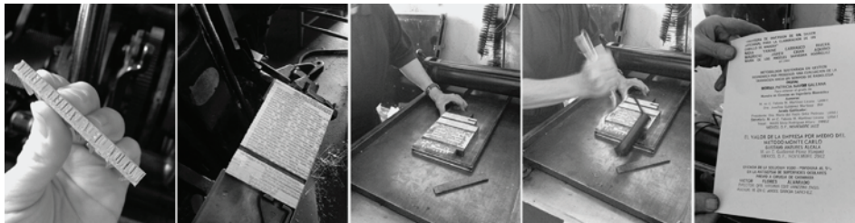
Imagen 2.9 Para dar una idea de cómo eran las líneas de linotipo, se muestra una de ellas con un nombre, seguida de una columna armada con un texto de prueba en el que se le entinta para revisar que esté correcto y se imprime con un pequeño tórculo o prensa de mano sobre papel. Los TGLM hasta antes de 1954 mandaban a hacer las líneas a otra imprenta. Fotografía: Mónica de la Barrera.
