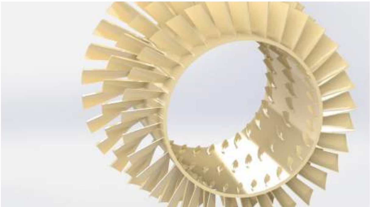
Figura 7.23 – Perfuração das paredes do disco central do compressor por suas lâminas
