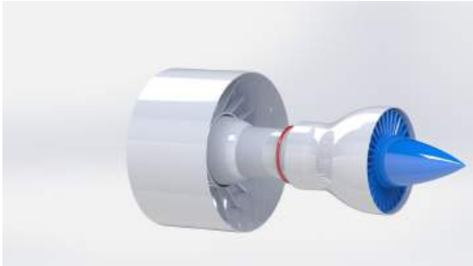
Figura 7.12 – Disposição da Carenagem Interna na Estrutura do Modelo
