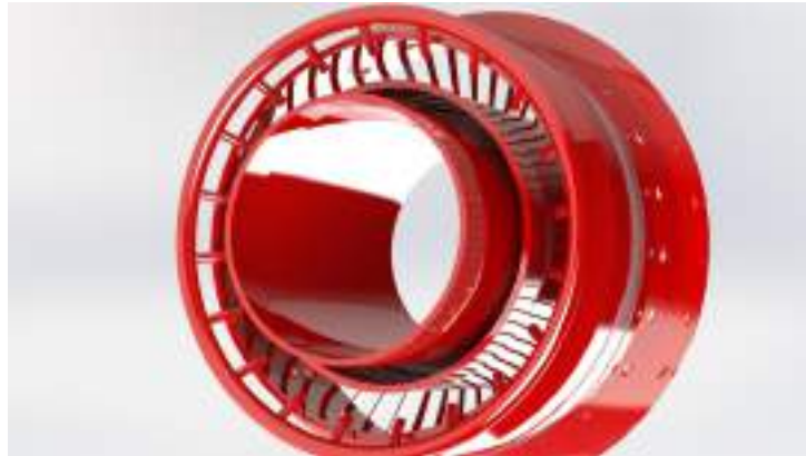
Figura 7.7 – Câmara de Combustão
