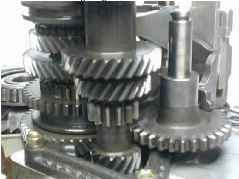
A maioria das engrenagens numa caixa manual tem dentes helicoidais. As três engrenagens que compõem a marcha a trás têm dentes rectos. A engrenagem dentada grande à direita desliza para colocar o carro em marcha a trás.
