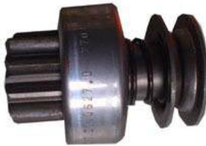
*Figura 34: Bendix do motor de arranque ([13])*
