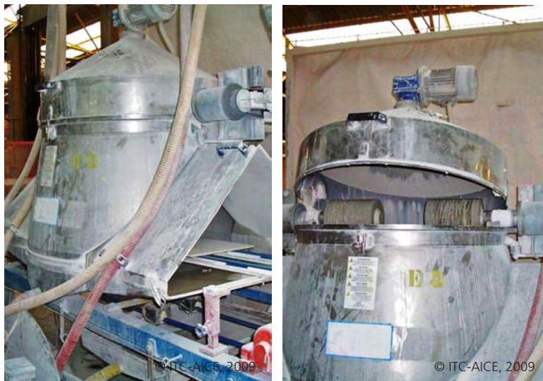
Figura 12 a y b. Sistema de esmaltado por pulverización a disco.
