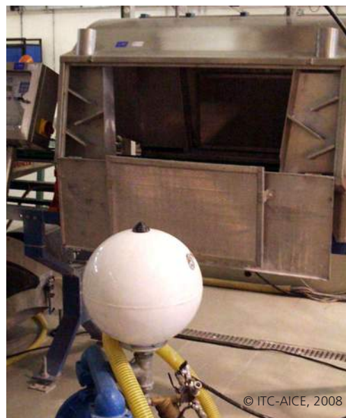
Figura 13. Sistema de esmaltado por pulverización con aerógrafo.
