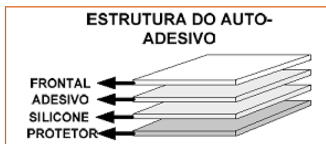
Figura 1- Estrutura do Autoadesivo
