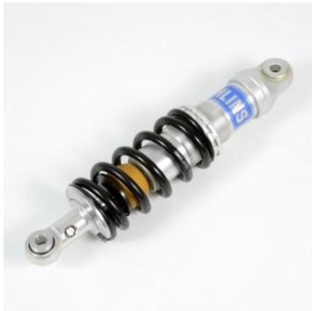
**Figura 7.3.** *Amortiguador de motocicleta de la casa Ohlins con muelle incorporado*
