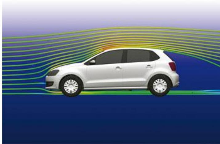
**Figura 8.5.** Simulación por ordenador de la trayectoria de las partículas de aire al pasar a través de un vehículo con una determinada velocidad
