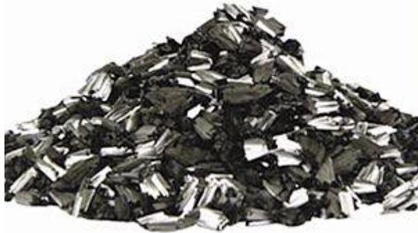
**Figura 6.2.** *Fibras de carbono picada*
