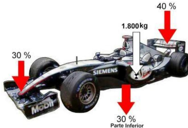
**Figura 8.4.** *Reparto de cargas aerodinámicas verticales en un F1*
