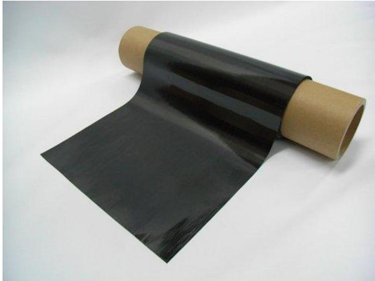
**Imagen 6.7.** *Bobina de fibras preimpregnadas (Prepreg)*
