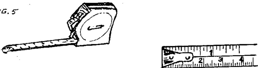
**GRADUACION DE LA CINTA.**- La cinta generalmente está graduada en metros, centímetros y milímetros; en el sistema inglés en pies, pulgadas y fracciones de pulgadas, algunas están graduadas hasta en dieciséis avos de pulgada.
