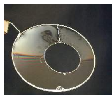
FIG. 4.4 : Mise en évidence des forces capillaires.
