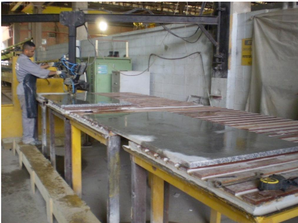
**Figura 4.57: Placa de granito sendo perfurada para fixação no painel de concreto (torres A e B)
