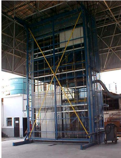
**Figura 2.16: Painel do Edifício *E-tower* montado na câmara de testes na AFEAL**
