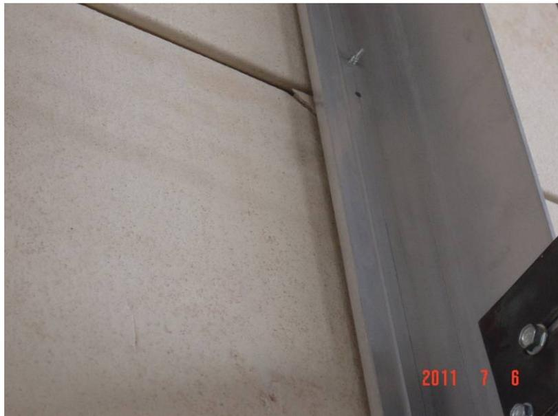
**Figura 4.137: Trecho da placa de cerâmica que se rompeu durante o ensaio**
