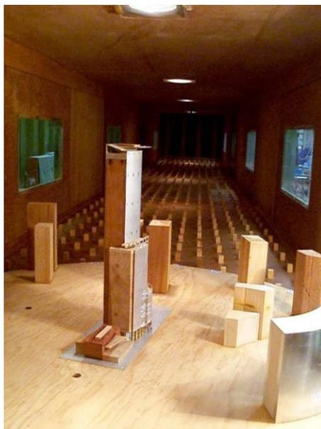
**Figura 2.15: Maquete do Edifício *E-tower* para ensaio no túnel de vento**
