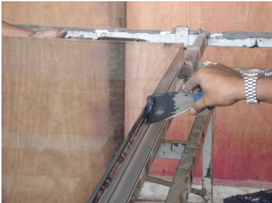
**Figura 4.39: Processo de colagem – raspagem do excesso de silicone**
