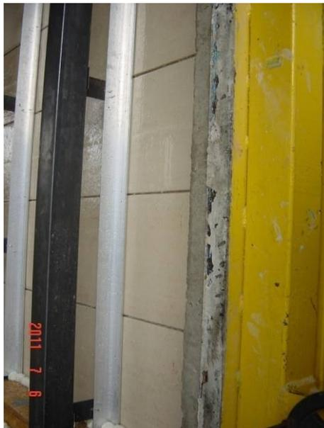
**Figura 4.143: Comportamento das placas cerâmicas quanto à estanqueidade com aplicação de carga de vento
