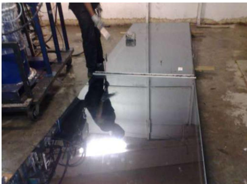
**Figura 4.102: Quadro com o vidro sendo colado apoiado no chão de maneira inadequada**
