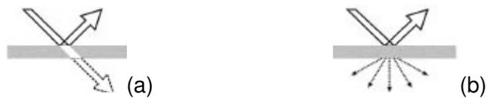
**Figura 2.48: Comportamento da luz atravessando um vidro plano liso (*float*) (a) e um vidro translúcido (b). Fonte: Caram *et al* (2007)**
