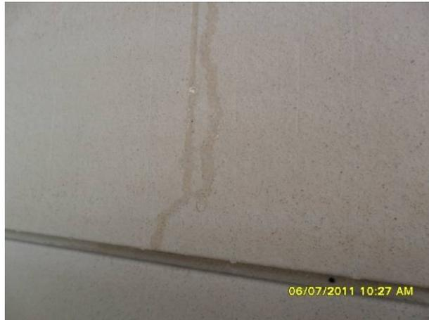
**Figura 4.142: Comportamento das placas cerâmicas quanto à estanqueidade sem carga de vento. Fonte: Arquivos da autora, foto tirada em julho de 2011**
