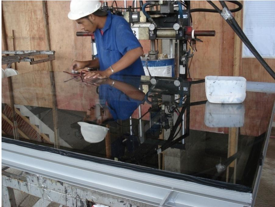
**Figura 4.40: Processo de colagem – limpeza fina do excesso de silicone**
