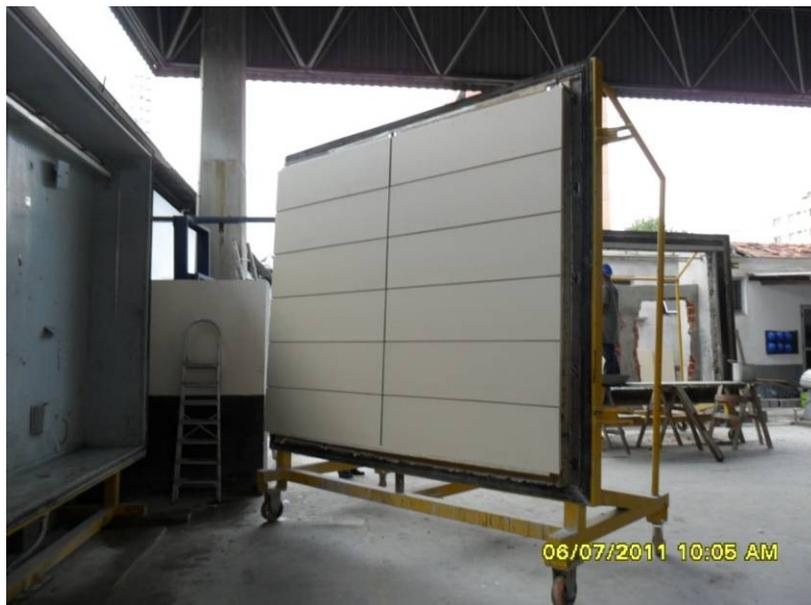
**Figura 4.124: Vista frontal do painel *mock-up* montado para o ensaio**
