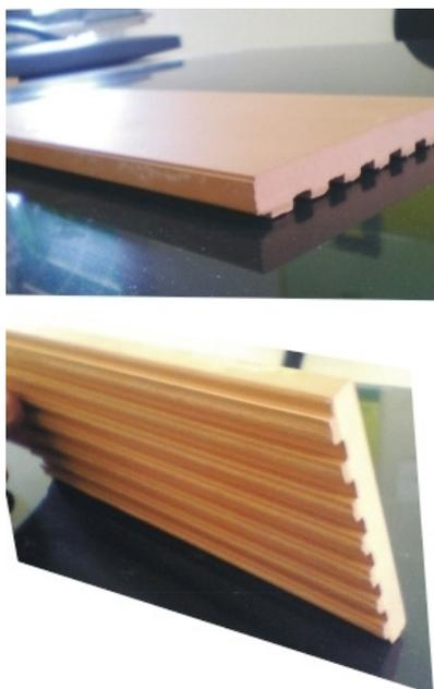
**Figura 4.109: Cerâmica extrudada**
