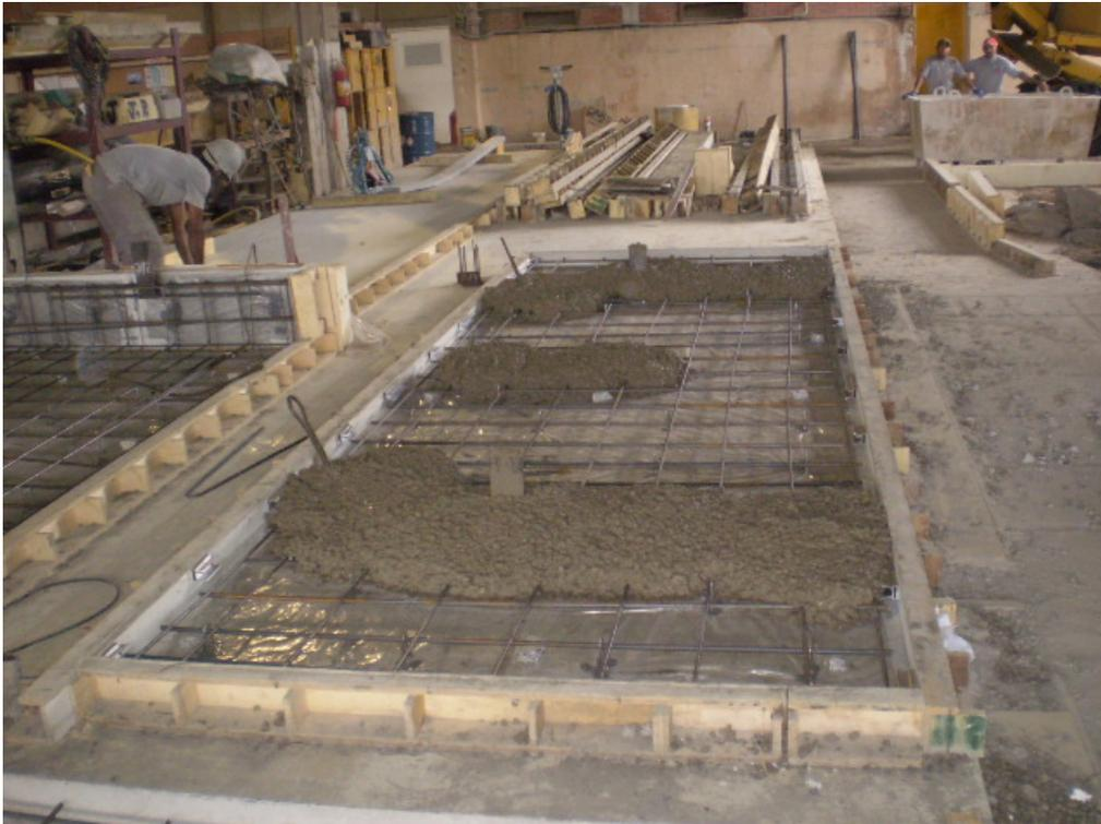
**Figura 4.60: Processo de fabricação dos painéis de concreto**
