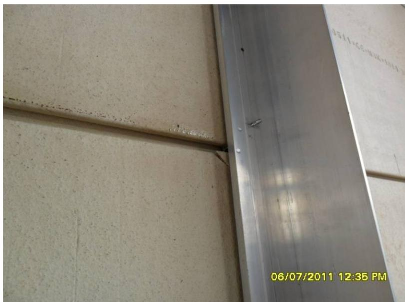
**Figura 4.138: Trecho da placa de cerâmica que se rompeu durante o ensaio**
