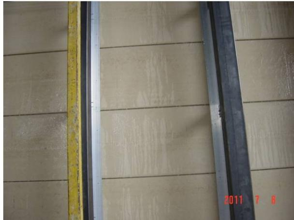
**Figura 4.144: Comportamento das placas cerâmicas quanto à estanqueidade com aplicação de carga de vento**
