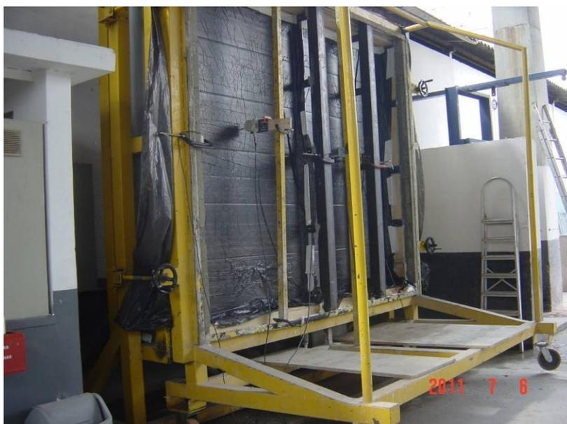
**Figura 4.135: Fachada totalmente vedada para o ensaio de cargas de vento**
