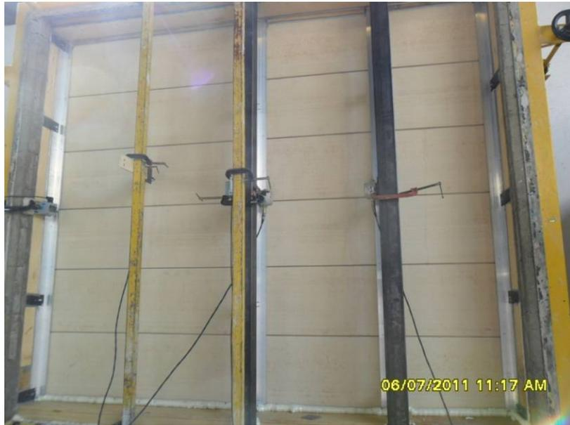
**Figura 4.132: Vista dos medidores de deflexão com perfil auxiliar para colocação do medidor no centro da placa**
