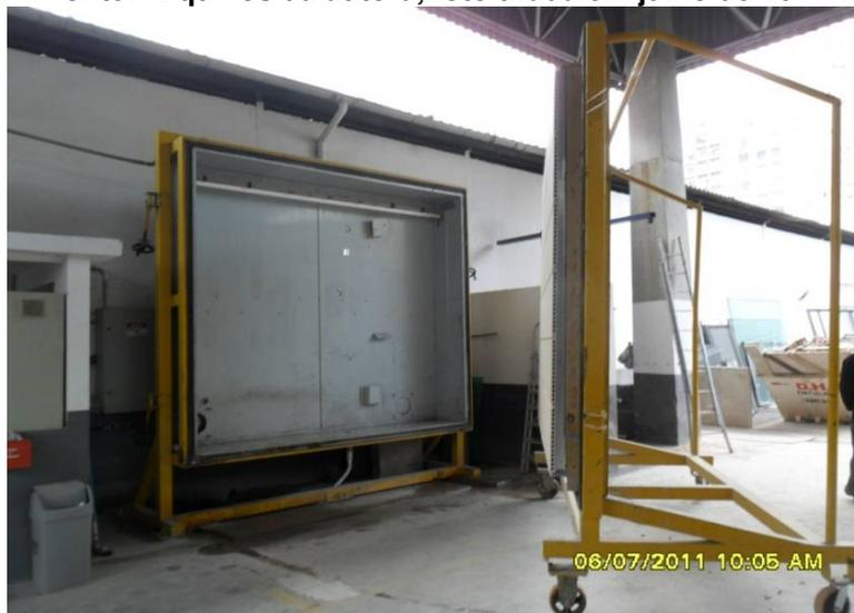
**Figura 4.126: Vista da câmara de ensaio e do *mock-up* montado para o ensaio**
