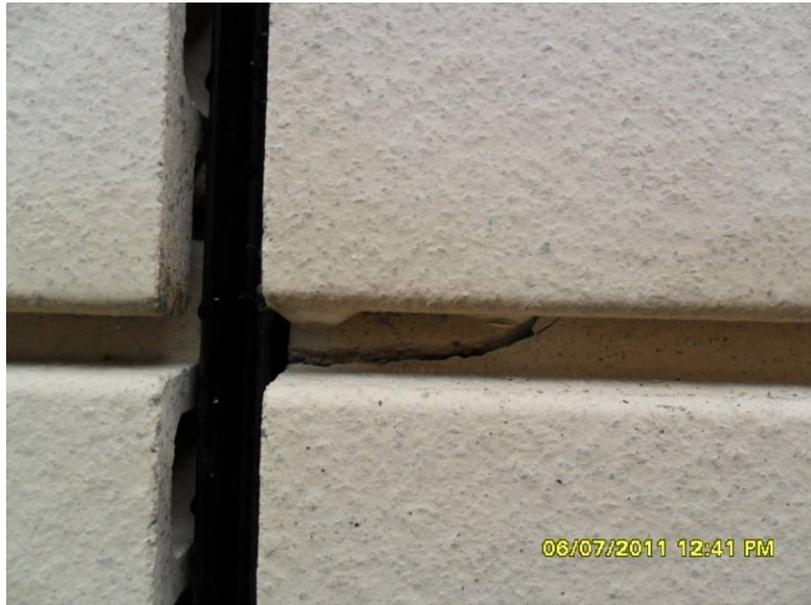
**Figura 4.136: Trecho da placa de cerâmica que se rompeu durante o ensaio**
