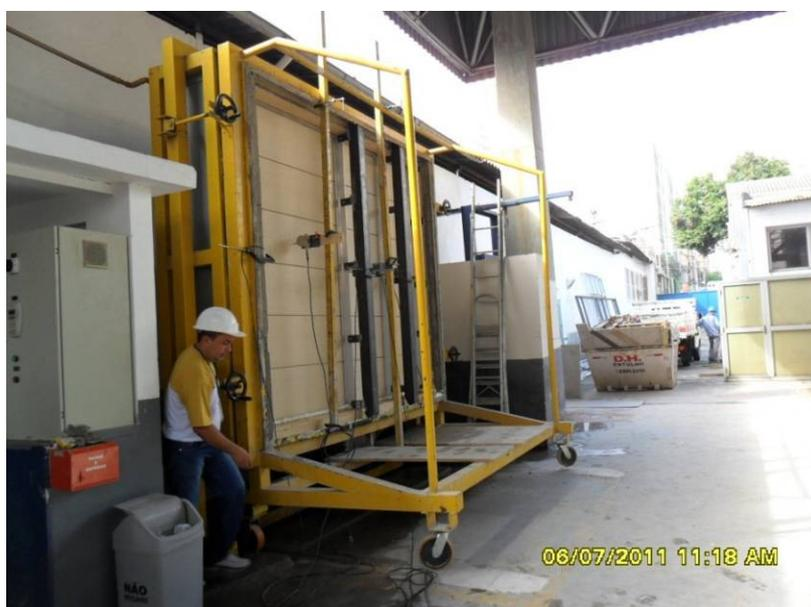
**Figura 4.131: Vista posterior do painel com os medidores de deflexão colocados**
