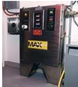
unidad provee 750 o 1500 VAC de energía de la salida al ROV vía el
