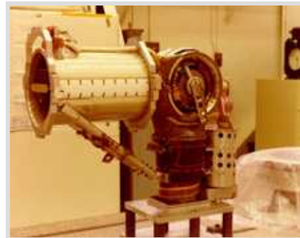
Los empalmes del Canadarm (mástil)
