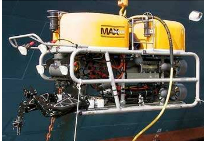
Rover MÁXIMO 2x4: Una Trabajar-Clase Profunda ROV De Submergence
