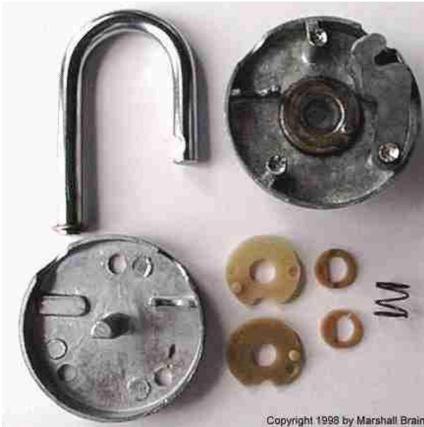
Existem normalmente três cames (o came é uma parte de uma roda ou eixo giratório ressaltada e projetada para transmitir um movimento alternado ou variável a um outro mecanismo) em um cadeado com segredo. Neste cadeado, um dos cames é de metal e ligado diretamente à parte dianteira que gira. Os outros dois cames são de plástico. Existem dois espaçadores de plástico que se ajustam entre os cames:
