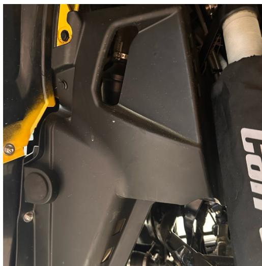
3. Для крепления теплового экрана используйте штатные отверстия на лонжероне рамы (расположен за задним креплением верхнего рычага)
